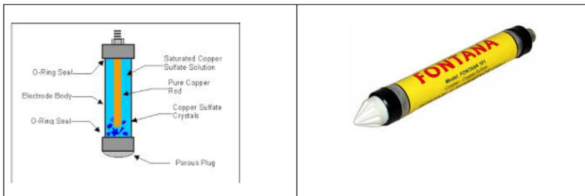
Figur 14.2.3. Referenselektrod av typen mättad koppar/kopparsulfat- elektrod (sat. Cu/CuSO 4 - elektrod). (Bild: Lena Sjögren).
