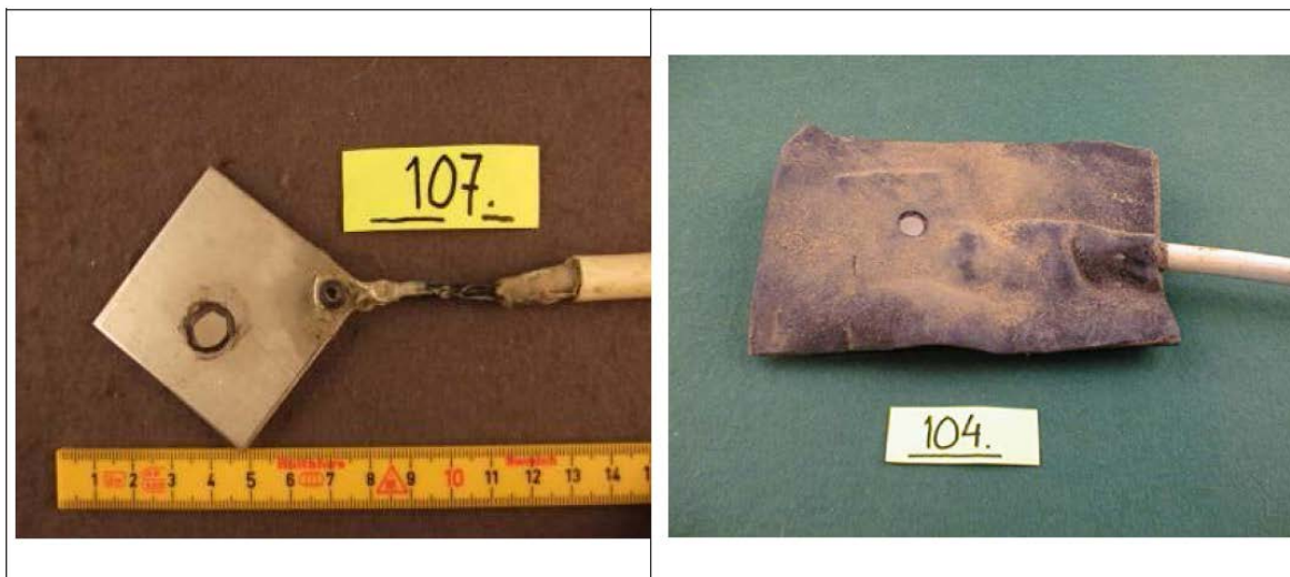
Figur 14.2:5. Mät- och provkupong. Till vänster: Innan tejpning. Hålet för fritt exponerad stålyta är tillfälligt markerat med tuschpenna. Till höger: Tejpad kupong med hål i tejen = mätyta. (Bild: G. Camitz)
