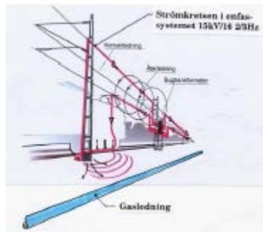
Figur 4:3. Induktiv och konduktiv växelspanningspåverkan på en gasledning från kontaktledningen hos en parallell, elektrifierad järnväg. (Bild: Banverket).
