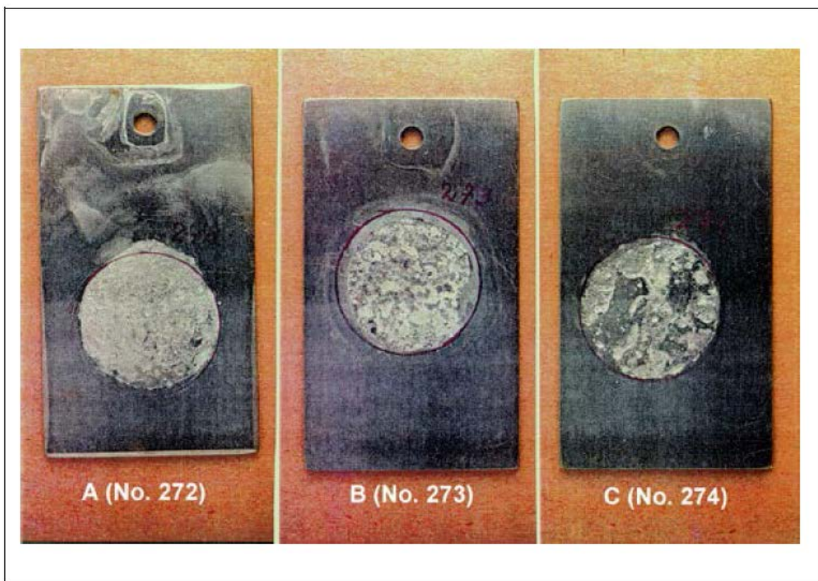
Figur 14.2:15. Tre olika angreppsformer vid växelströmskorrosion på katodiskt skyddade provkuponger efter cirka 1½ års exponering för växelström med olika strömtäthet. Kupong A (No. 272): Jämn korrosion, Kupong B (No. 273): Stor mängd ytliga lokala angrepp belägna intill varandra, Kupong C (No. 274): Mycket djupa, sammanhängande lokala angrepp. Däremellan är med icke angripen stålyta. (Foto: G. Camitz)
