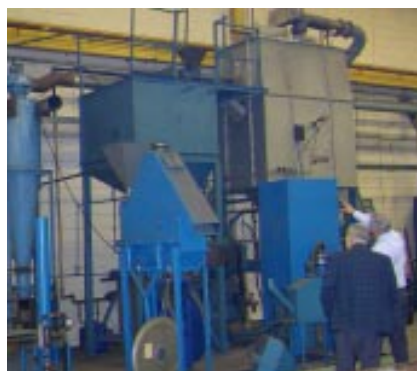
Bilden visar en pilotanläggning för återvinning av gjutsand hos den engelska tillverkaren Richards.
