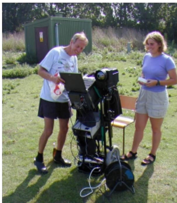
Under 2001 genomfördes studier av hur naturgas sprider sig. Med hjälp av en IR-kamera kan gasen urskiljas om det finns en temperaturskillnad mellan gasen och marken.
