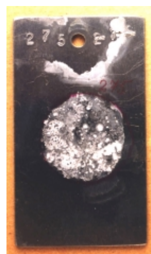
Ställedningar som utsätts för växelströmspåverkan kan få omfattande korrosionsskador. Bilderna visar två provkupper som vid olika markförhållanden utsatts för en växelspanning på 30V.
