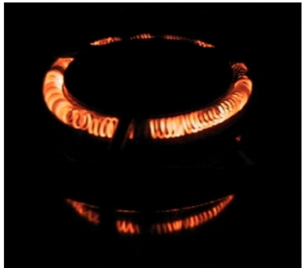
I denna spisbrännare bildas försumbara mängder NO x eftersom förbränningen sker katalytiskt.
