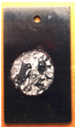
Ställedningar som utsätts för växelströmspåverkan kan få omfattande korrosionsskador. Bilderna visar två provkupper som vid olika markförhållanden utsatts för en växelspanning på 30V.
