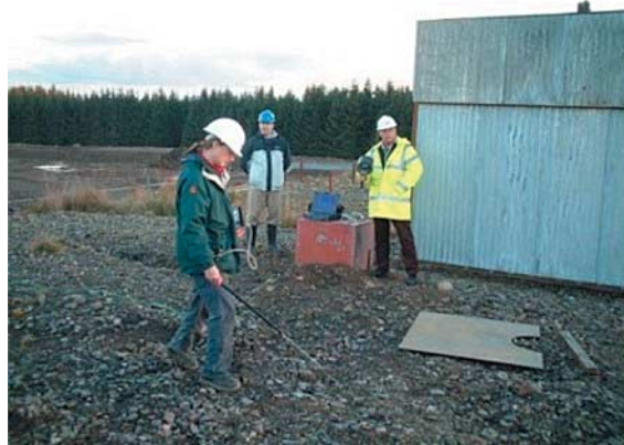
Det nya mätinstrumentet (hos mannen i gul rock) testas parallellt med konventionell teknik. Plats: Advanticas testanläggning i Spadeadam, England.
