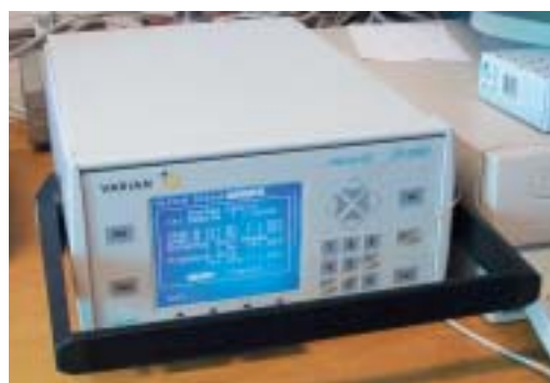
Gaskromatografi är en metod för att bestämma innehållet av exempelvis metan och koldioxid i biogasen.
