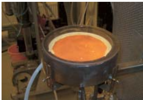
I den nya spisbrännaren sker förbränningen katalytiskt utan synlig låga och utan NO 2 -emissioner.
