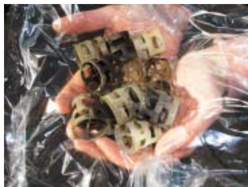
Fyllkropparna finns i skrubbern för att skapa stor yta mellan gas och vätska. När fyllkropparna sätter igen med organiskt material försämras denna funktion och de behöver tvättas. (Foto: Rikard Johansson)
