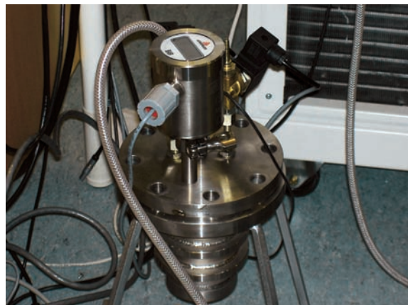
På Luleå Tekniska Högskola genomförs försök med ultraljud för mätning av gaskvalitet.
