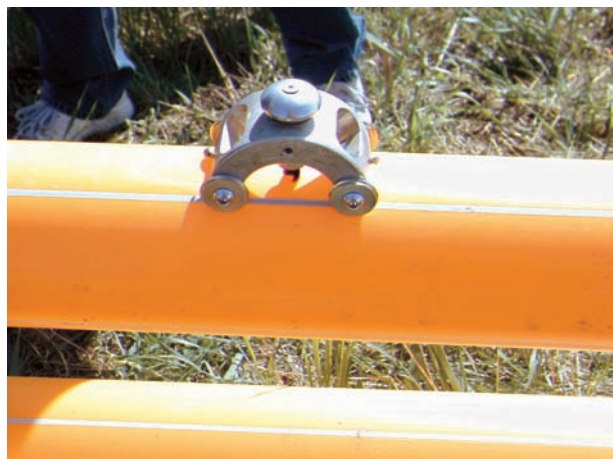
Rör med mantel av polypropen har under 2005 blivit populära på grund av ökad motståndskraft mot yttre åverkan vid hantering och läggning.
