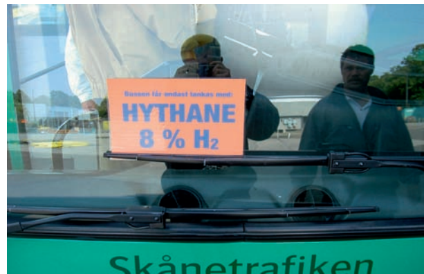
Blandningar av vätgas och naturgas har använts under två år som bränsle i två stadsbussar i Malmö.
