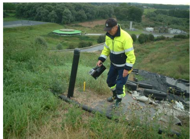
Laserinstrument används för att kartlägga gasläckage från deponier. (Foto: NSR)
