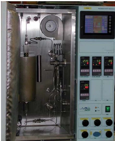
Mikroreaktor för test av katalysatorer. (Foto: Sven Järås, Kemisk teknologi, KTH.)
