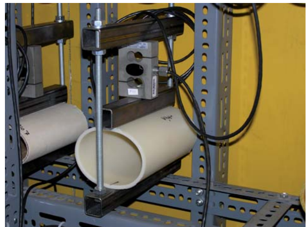
Rörprov satt under konstant ovaliseringsdeformation.
