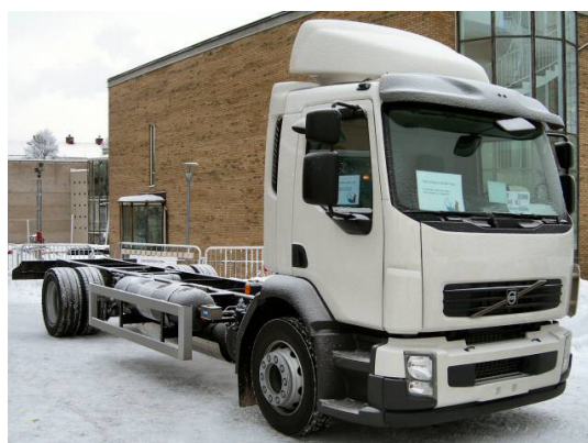
Slaka Potatis är en av åtta åkare i Sverige som under 2010 har gjort fältprov med en Volvo FL/FE 7-liters diesel, konverterad till metandieseldrift med Hardstaff-teknik.
