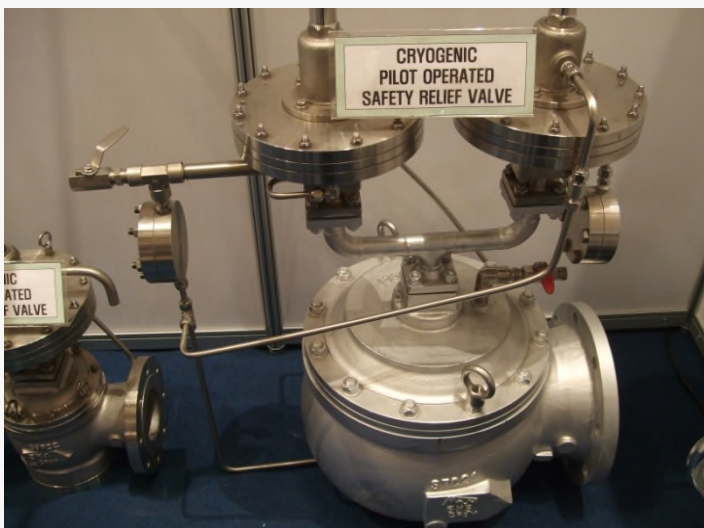
Säkerhetsventiler för LNG
