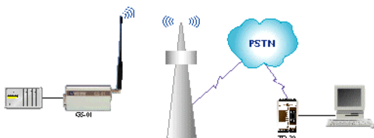
Figur 1 Kommunikation via GSM modem
