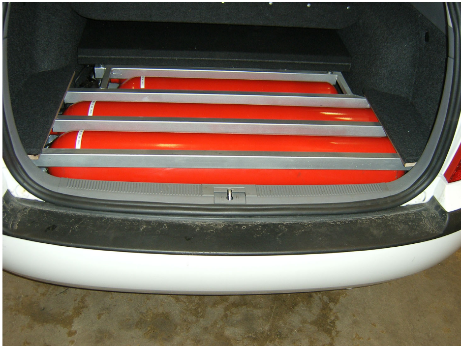
Bilden visar tankinstallationen i Skoda Octavia 1,6 Combi. Ytterligare illustrationer av installationen återfinns i bilaga 5.
