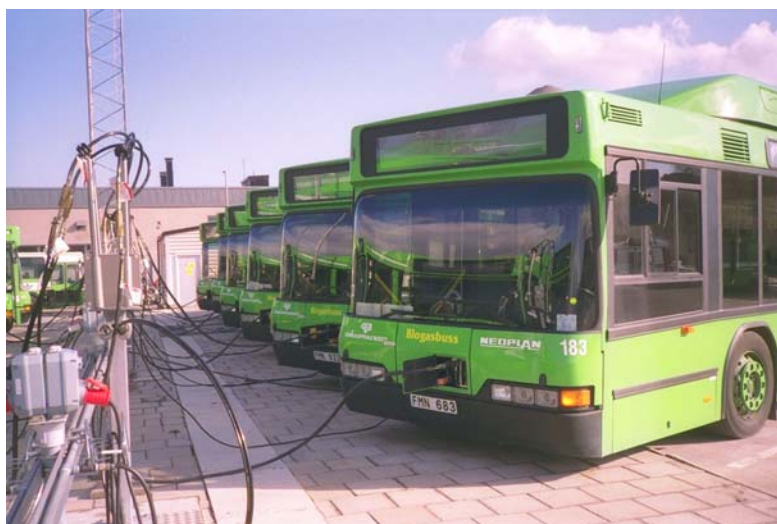
Figur 29. Långsamtankning av biogasbussar.
