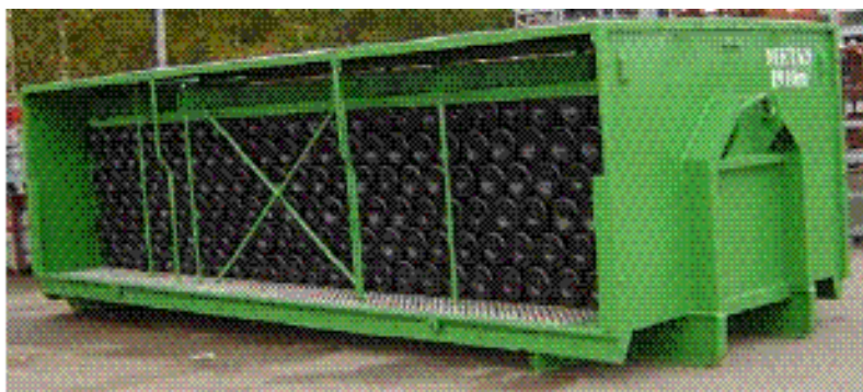
Figur 24 Gasflaskor på flak.
