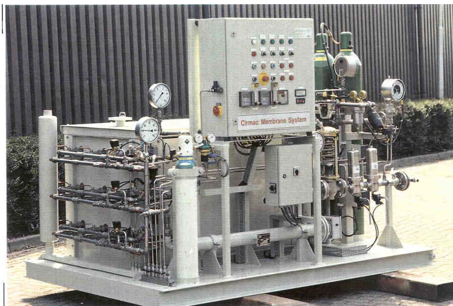
Figur 20. Gasbehandling med membran
