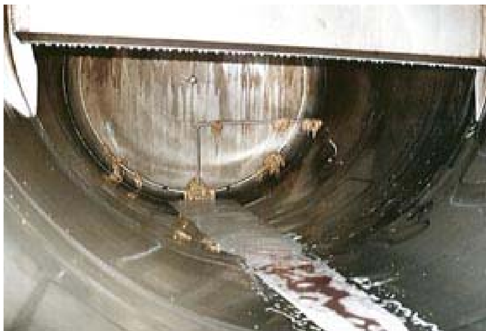
Figur 1. Insidan av en ursköljd bil som transporterat slakteriavfall. Material fastnar på exempelvis omrörare och måste ibland tas bort manuellt. Bild: Nils-Gunnar Ericsson
