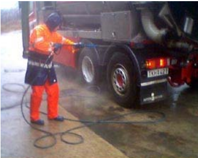
Figur 2. Utvändig rengöring med högtrycksspruta med 70 grader varmt vatten. Bild Annika Ekvall
