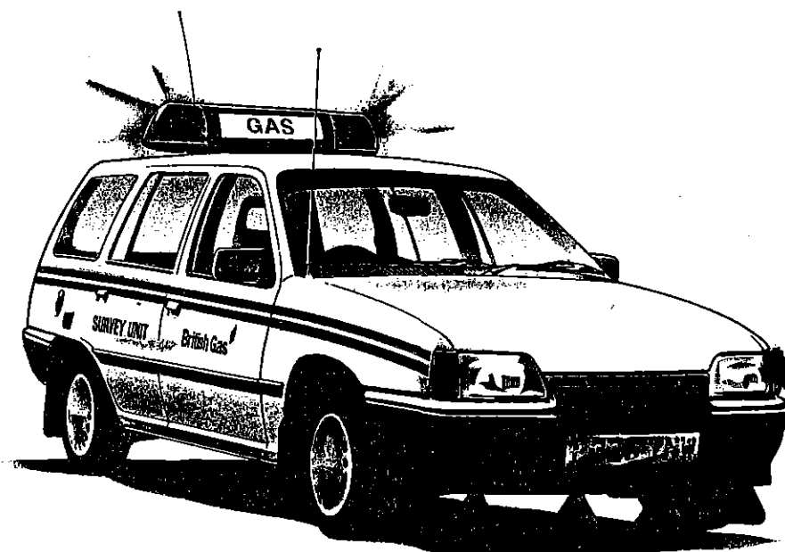
Figur 7. Fordon för läcksökning av gasledning [22]
