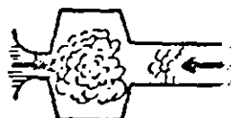
4. Trycket höjs av de tillbakaströmmande gaserna. Därefter sker en ny antändning
