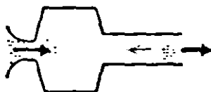
3. Ny bränsleblandning och en del av förbränningsgaserna sugas tillbaka.
