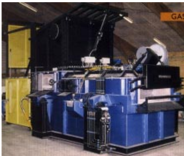
Figur 7.13. Schaktugn för aluminiumsmältning av fabrikat Stotek
