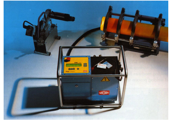
Bild 1 Datoriserad stumsvetsutrustning stumsvetsningen. Bild nr 1 visar en sådan utrustning.
