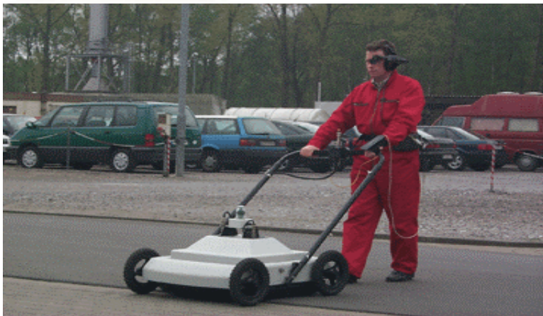
Figur 4. Exempel på ledningslokaliseringstrustning, Interrigator II och Pathfinder.
