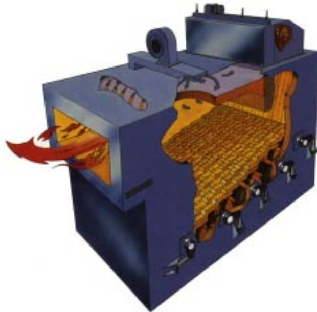
Figur 2.5 Genomskärning av förugn till rostpanna [68]
