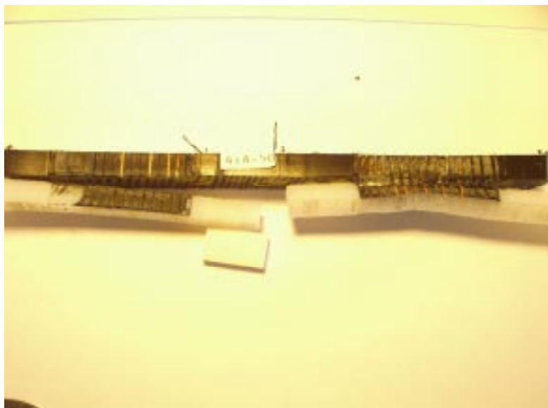
Figur 3. Resultat av slagprov på elektromuff.
