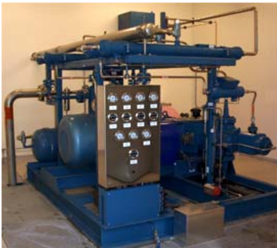
Figur 21: Högtryckskompressor (Kompressorn på bilden har ingen koppling till texten.) (Foto: Margareta Persson)
