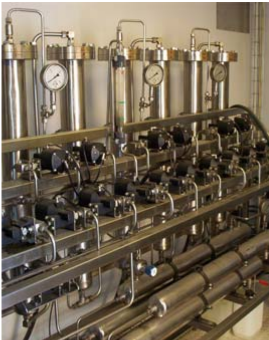
Figur 6: Pilotanläggning med PSA, Helsingborg (Foto: Margareta Persson)
