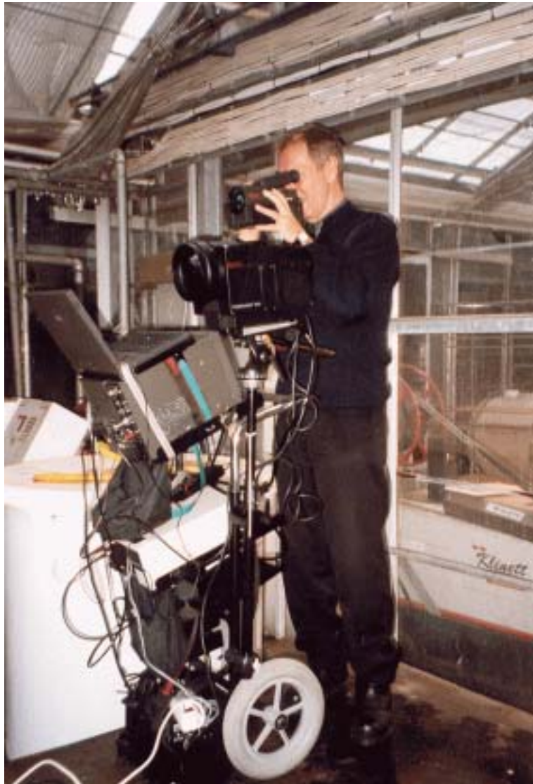
Figur 4.5: Utrustning för termografering av växtbeståndet. (Foto: H.K. Schüssler)
