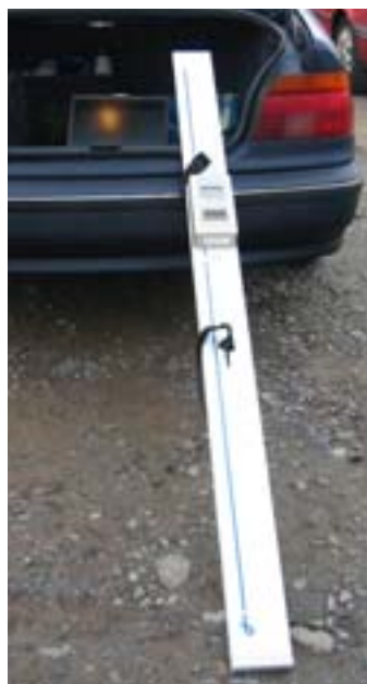
Figur 6.1. Mätutrustning för elektromagnetisk bredbandssondering GEM-2 från Geophex.
