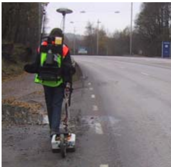
Figur 5.2. MALÅ GeoScience:s radarutrustning RAMAC X3M i kombination med 500 MHz samt RAMAC Monitor för datainsamling.
