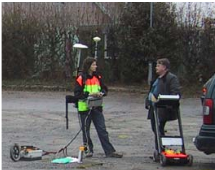
Figur 5.15. Till vänster RAMAC X3M med en 500 MHz skärmad antenn och GPS inkopplad. Till höger Easy Locator med en 500 MHz skärmad antenn. Båda med RAMAC Monitor.
