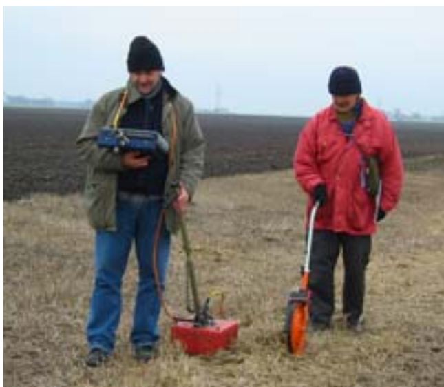
Figur 5.10. Till höger GSSI-SIR3000 med en 400 MHz antenn och till vänster Easy Locator med skärmd antenner 500 MHz. Figur 5.11. GSSI-SIR3000 monitor.
