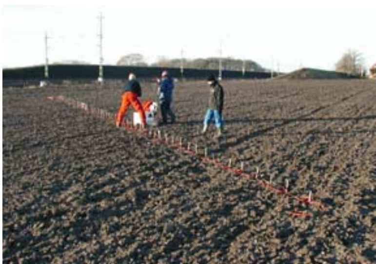
Figur 6.3. Resistivitetsmätning på åker utanför Landskrona. Utlägget är 40 meter och förlängs efter första mätningen med 10 meter och efter andra mätningen 10 meter till bort mot järnvägen.
