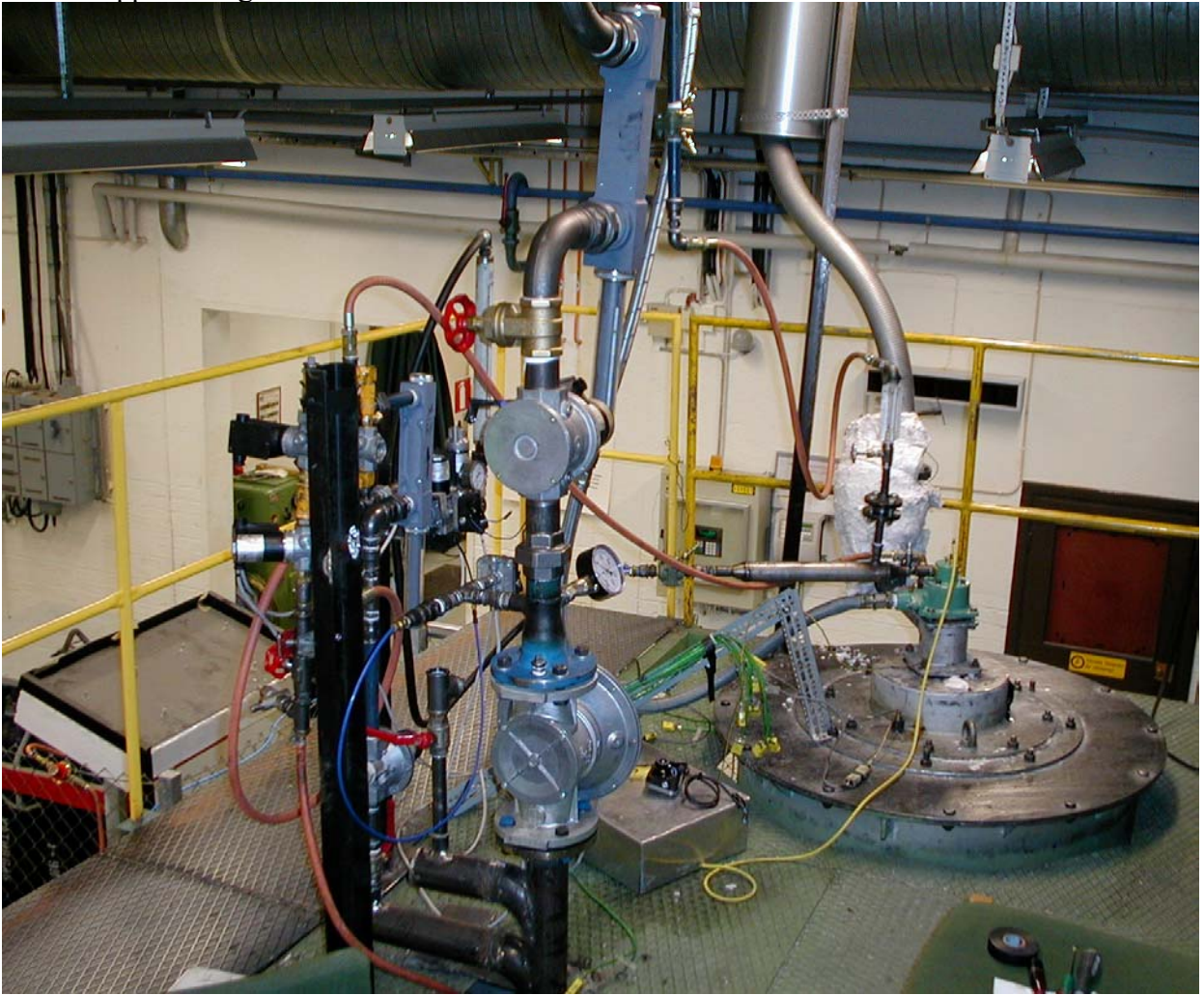
Bild 2. Till vänster i bild ses tryckregulatorer samt flödesmätare av svävkroppstyp. Till höger brännaren vertikalt monterad i provläge.
