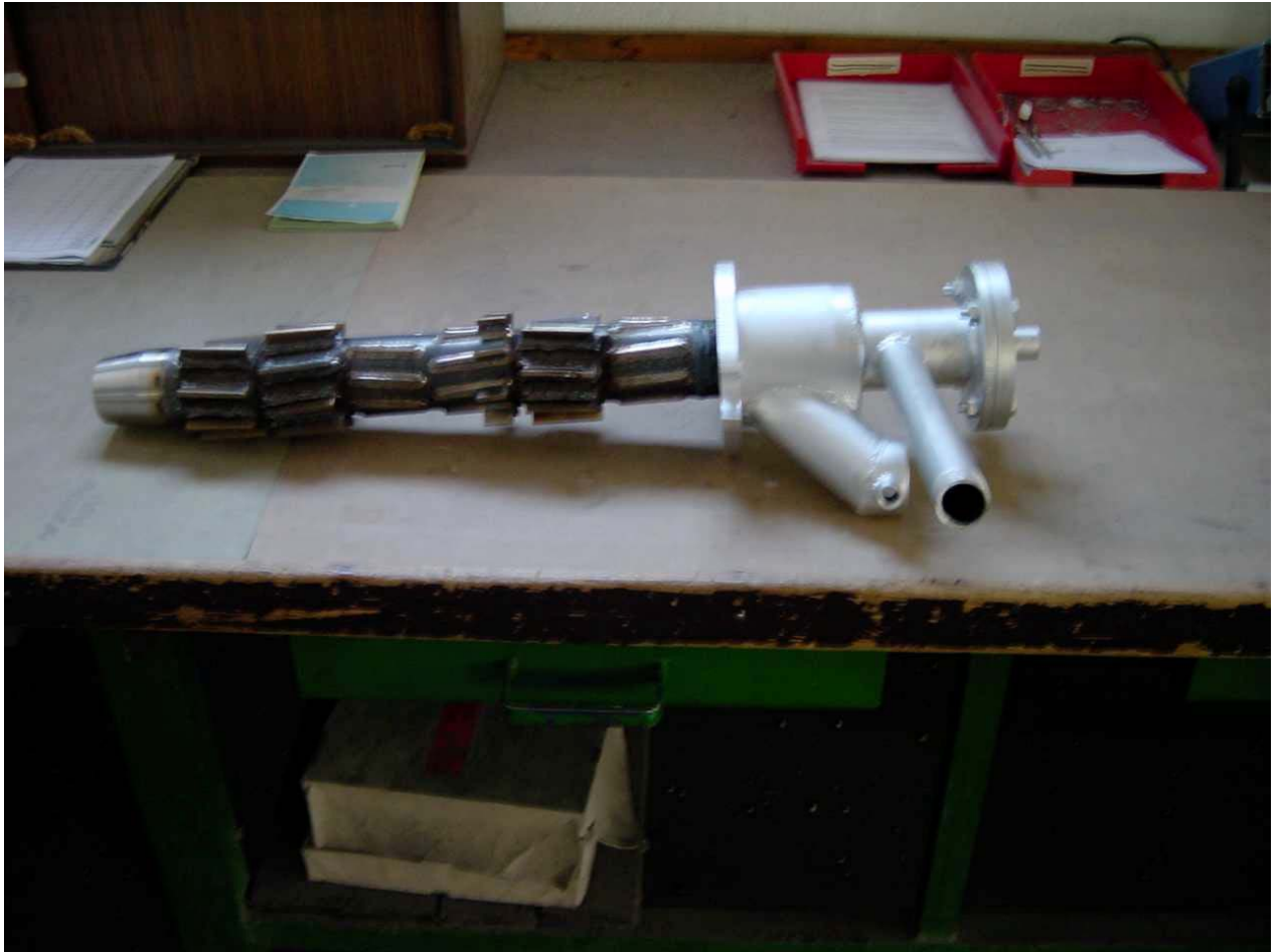
Bild 1. Brännare av SER typ. Notera fenorna längs efter recuperatorn vilka ger möjlighet till hög värmeåtervinning. Fenorna sitter i både utgående avgasflöde och inkommande förbränningsluftsflöde dvs går genom rekuperatorröret.
