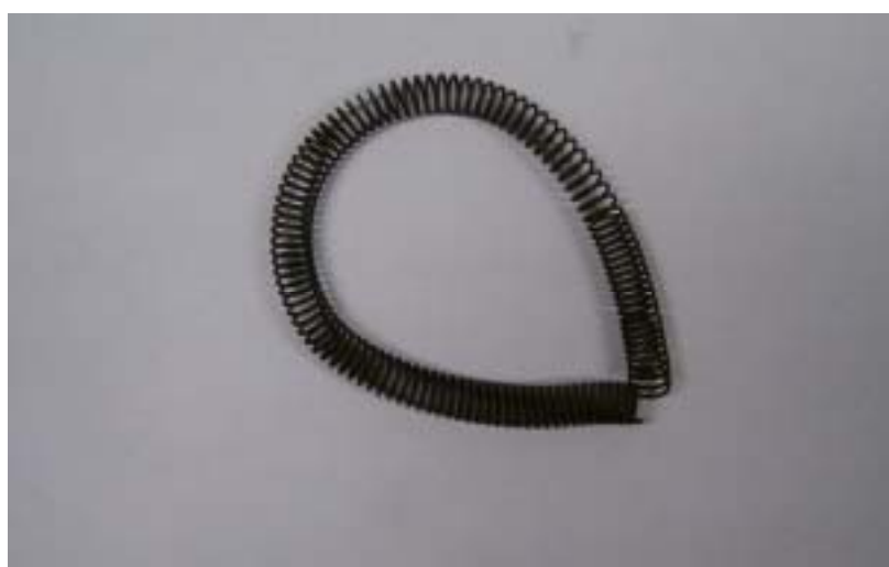
Figur 1. Foto av en katalytisk spiral tillverkad enligt Catators patenterade teknik.
