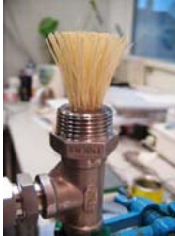
Figur 20. Hålfibrer som biogas ska ledas in till (Harasek, 2006).
