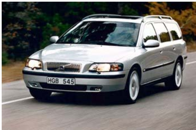
Figur 5. Volvo V70 Bi-Fuel drivs med fordonsgas (bild från www.volvocars.com ).
