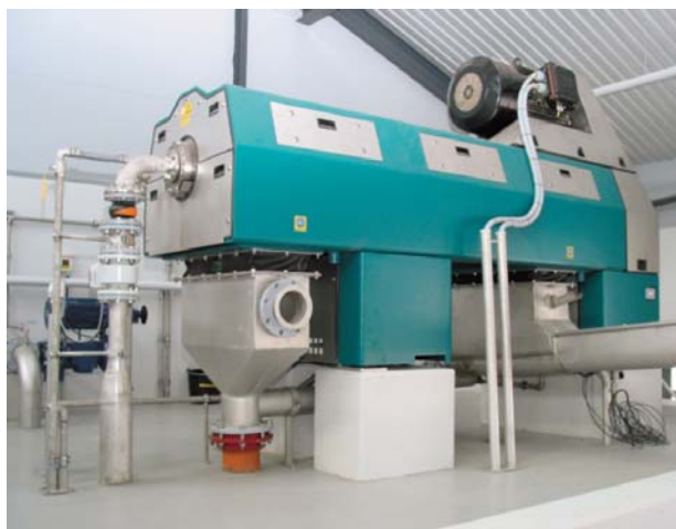
Figur 10. Dekantercentrifug från Westfalia Separator. Används vid Svensk Växtkraft i Västerås.
