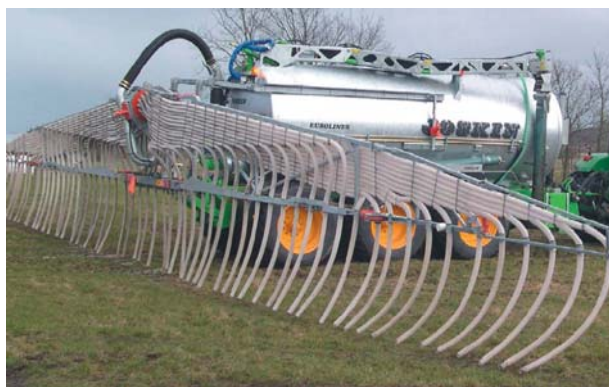
Figur 12. Konventionell spridning av flytgödsel eller flytande rötrest 36 .
