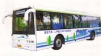
中国で開発されたDME大型バス 2005年 上海交大大学・上海汽車工業(集団)会社が共同で開発した大型DMEバス
