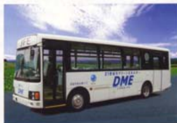
②いすゞエルガ・ミオ 2001年 いすゞ中央研究所が開発。現在、JFEスチール内で構内バスとして走行。コモンレール噴射。
