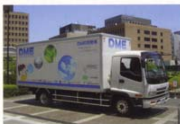
①いすゞ フォワード 2004年 DME自動車実用化研究開発グループが開発したGVW8トン中型タイプ。新潟・つくば・横浜間の長距離走行実験中。国土交通大臣認定車第4号。列型噴射。
