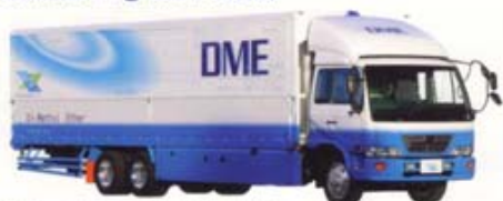
日産ディーゼル コンドル GVW20トン 2004年 国土交通省/次世代低公害車開発促進プロジェクトで(株)交通安全環境研究所と日産ディーゼル工業(株)が共同で開発試作したDME大型トラックGVW20トン 列型噴射システム
