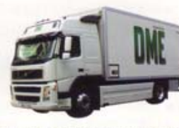
スウェーデンで開発されたDMEトラック 2005年 ボルボが開発した大型DMEトラック
