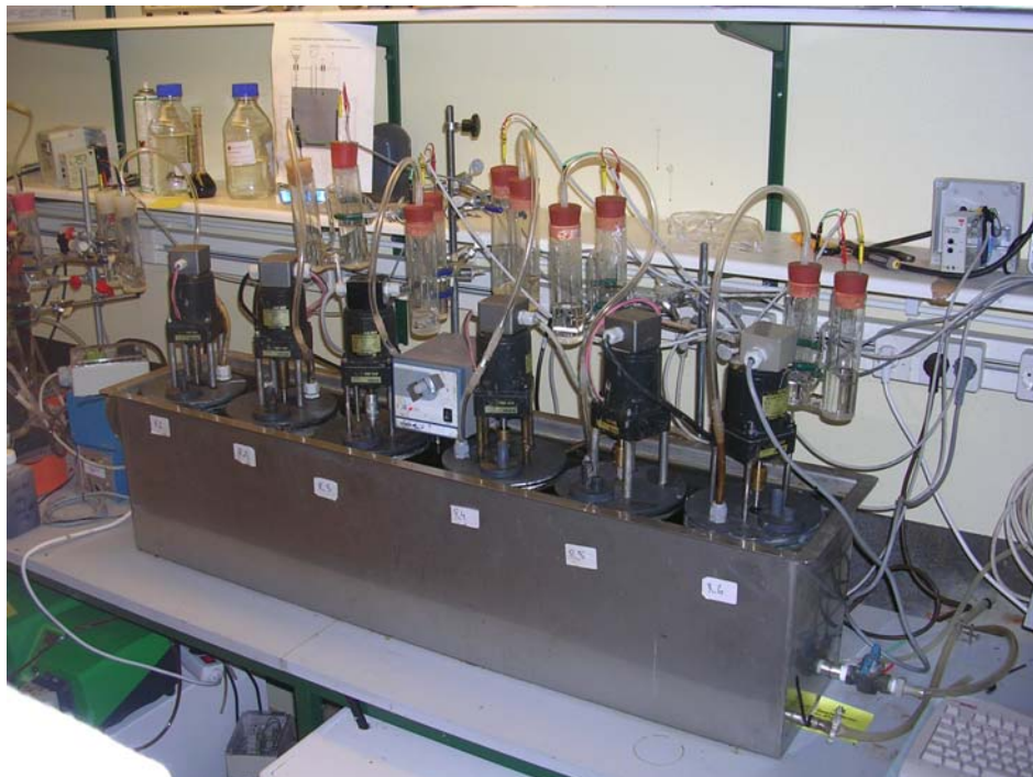
Figur 3 Kontinuerliga biogasreaktorer på AnoxKaldnes laboratorium i Lund.
