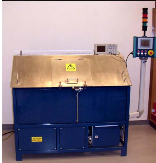
Figur 2 Elektroporationsanläggningen i forskningslaboratoriet vid Luleå Tekniska Universitet.
