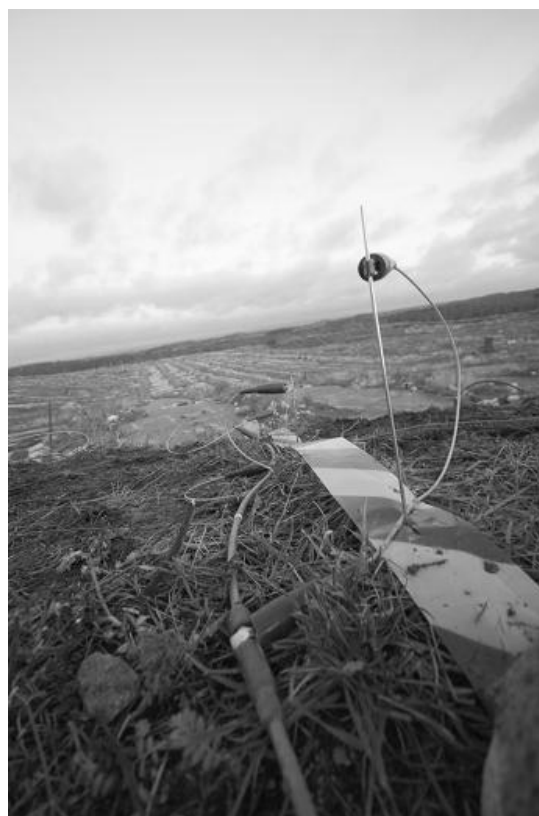
Figurer 14.5 och 14.6. Kablar och elektroder som för strömmen ner i marken.
