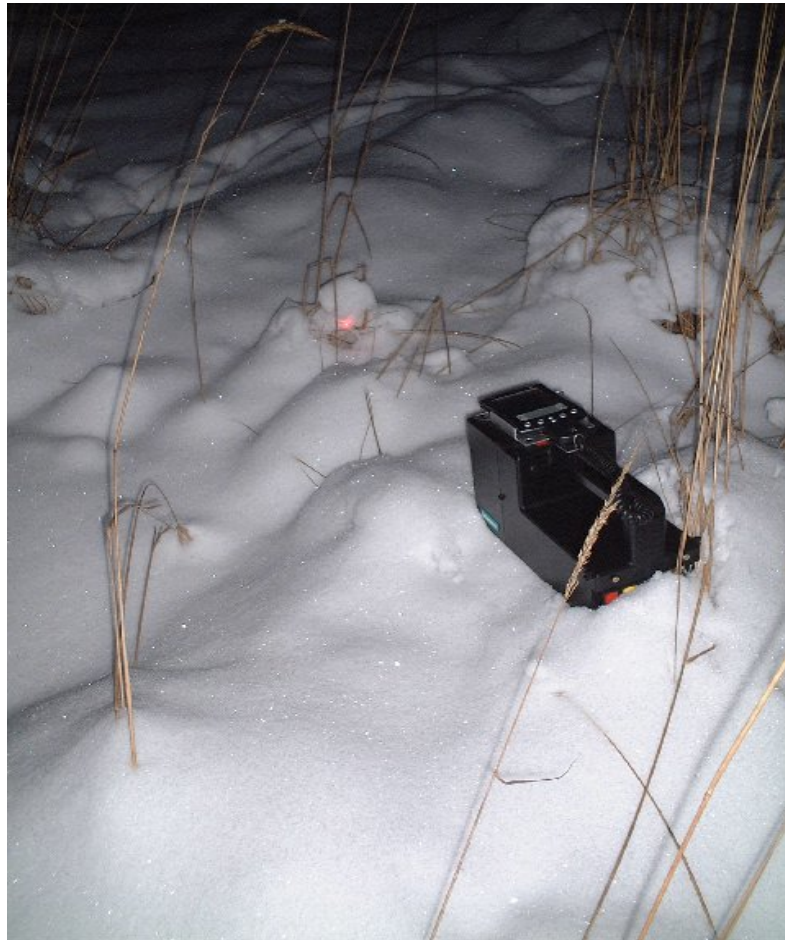
Figur 12.32. Energicell 89, Hagby. Metanemissioner via kanaler som uppstått genom att vinden satt långa styva grässtrån i rörelse, 1000-3000 ppm, registrerat med Siemens lasersystem. Snötäcke, 2-3 dm.
