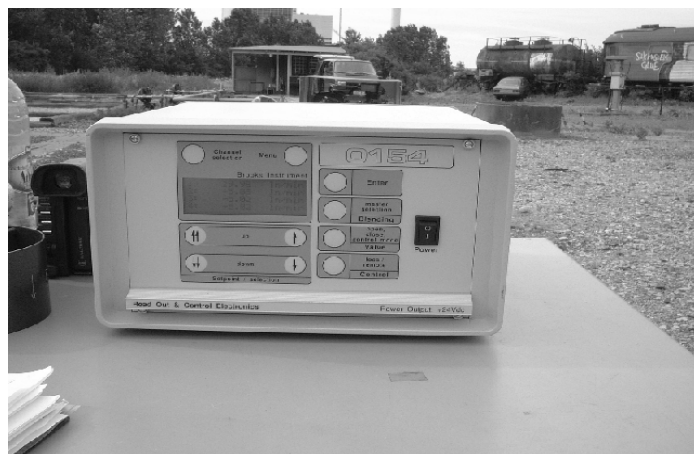
Figur 12.3_ Brooks “Smart Mass Flow Meter”, 5800 serien, för reglering av metangasflöden (v). Brooks mikroprocessor (0154 BC1B3) för att selektera och kontrollera gas mass-flöde (h).
