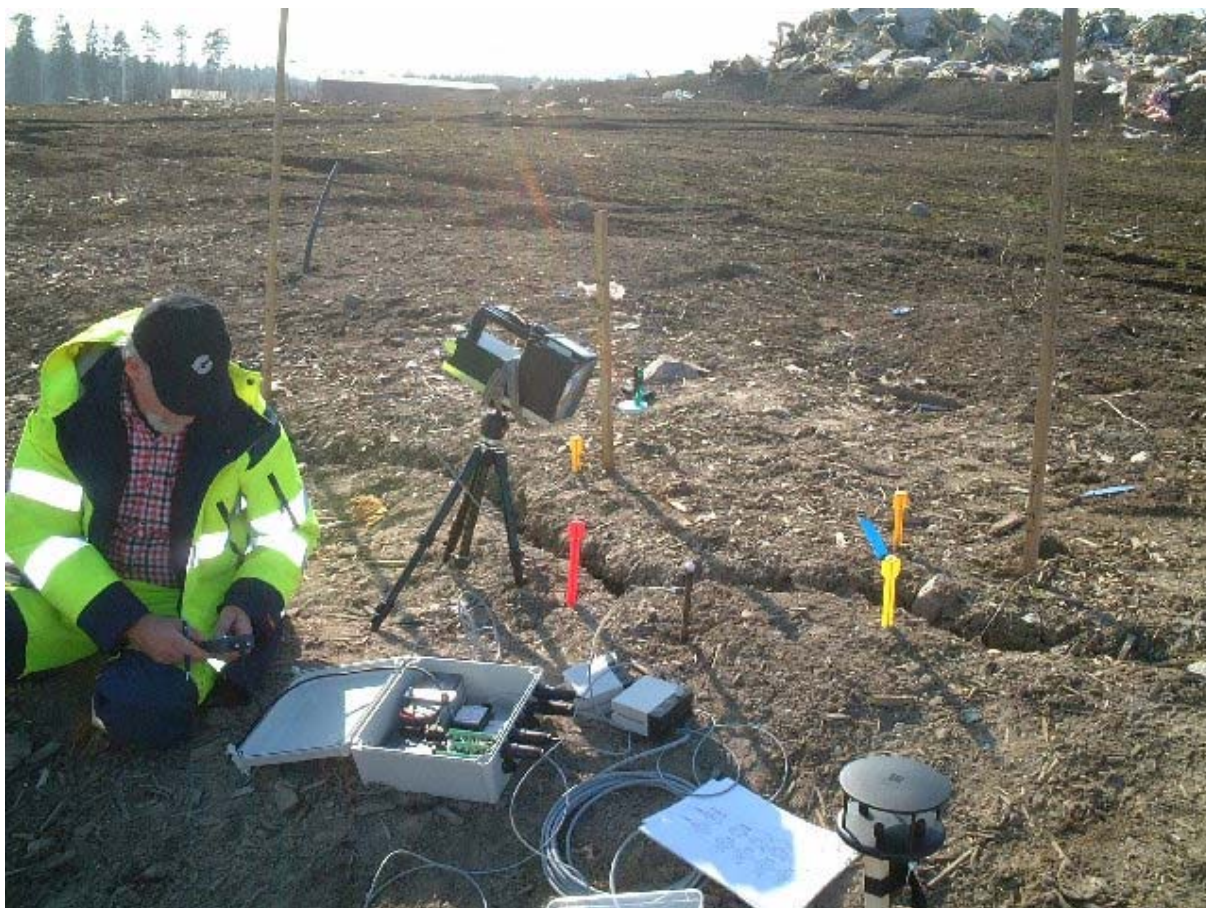
Figur 12.5. Forsbacka, F2-området, överyta på totalt ca 1200 m 2 m med blandat hushållsavfall, löst täckskikt och sprickzon p.g.a. sättningar i deponin. Mätning med laser samt fältmätutrustning för mätning av fältreferensdata, med logger som lagringsmedia.
