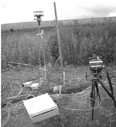
Figur 10.2. Vänstra bilden visar logger med mätsystem för mätning av referensdata för mätning av väder- och utstrålningsparametrar, deponitryck, gastemperatur vid läckagekällan, vindhastighet, atmosfärstryck etc. Högra bilden visar samma mätsystem uppställd för detaljerad mätning av metankoncentration direkt vid läckagkällan.
