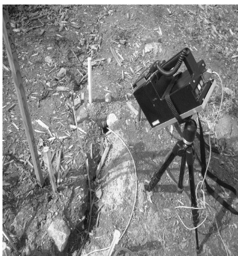
Figur 10.2. Vänstra bilden visar logger med mätsystem för mätning av referensdata för mätning av väder- och utstrålningsparametrar, deponitryck, gastemperatur vid läckagekällan, vindhastighet, atmosfärstryck etc. Högra bilden visar samma mätsystem uppställd för detaljerad mätning av metankoncentration direkt vid läckagkällan.
