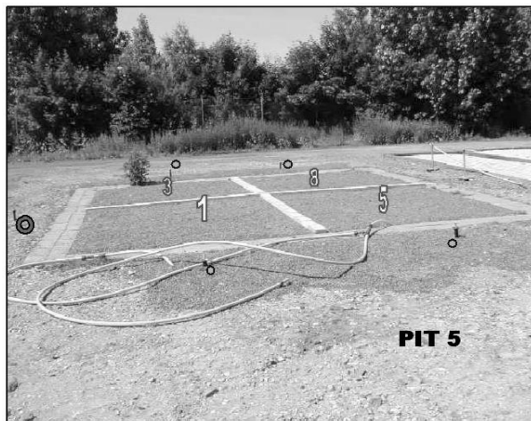
Figur 12.1. v. Kvadratisk fältsmätare med 4 kvadranter, en gaskulvert med 1, 3, 5 resp. 8 mm hål, placerade 10 cm under markytan, ytmaterial grov singel.
