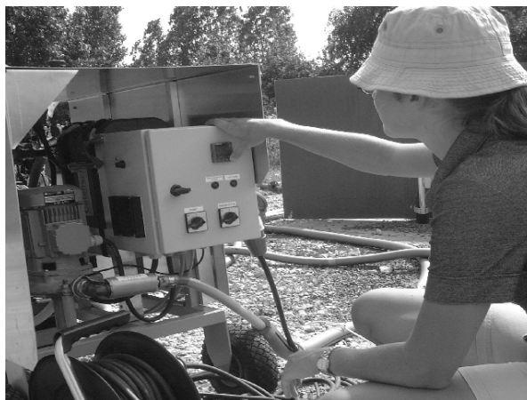
Figur 12.2. Referenstemperatur panel (v), ansluten till en temperatur regulator (h).
