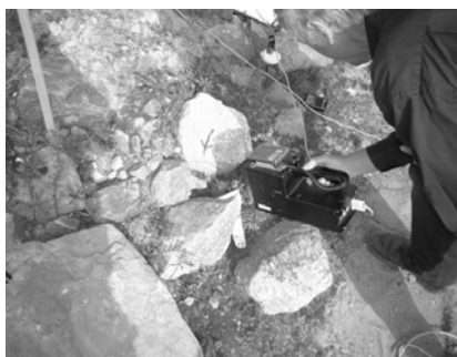
a) metanläckage vid stenparti 500-7000 ppm
