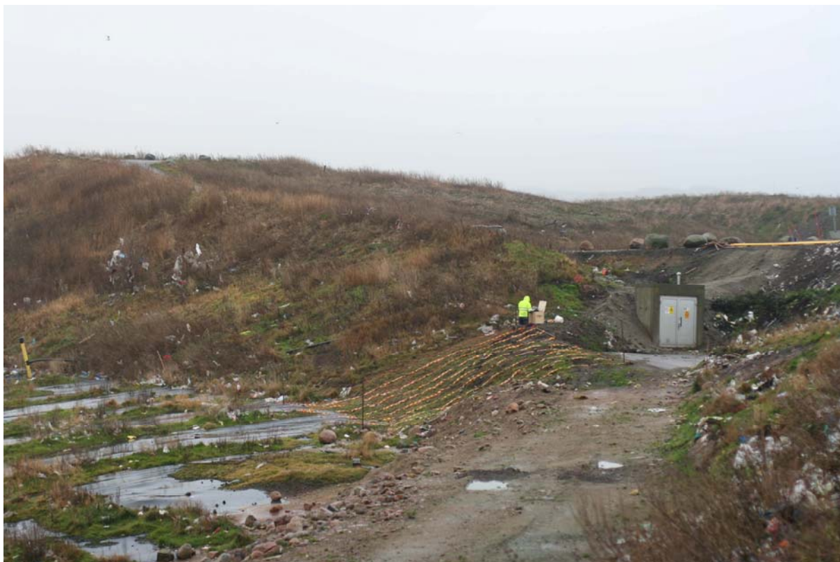
Figur 14.2. Området för fältexperimenten. De gula banden visar placeringen av de elva linjerna där resistivitmätningarna utfördes.
