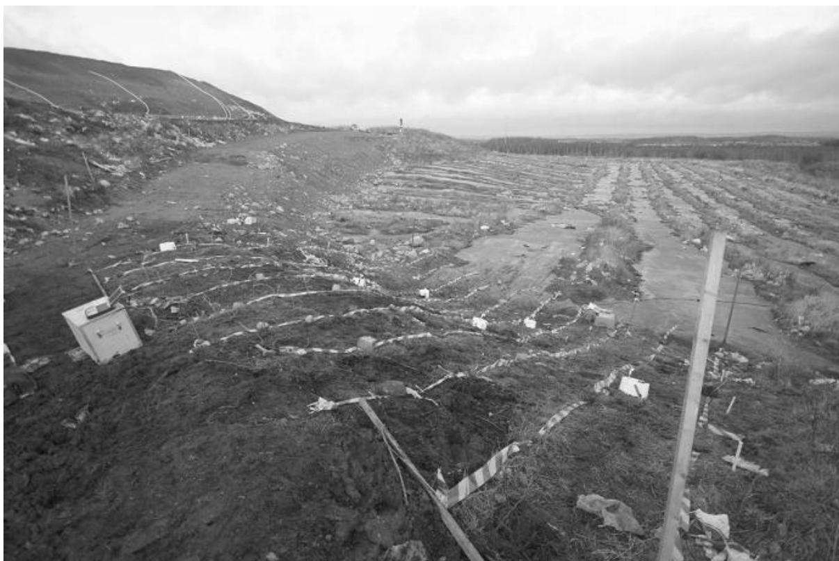
Figur. 14.3. Området för fältexperimentet som visar uppställningen för resistivitetsmätningar och de statiska kamrarna. Linje A är längst till höger i bilden (jämför figur 14.4).
