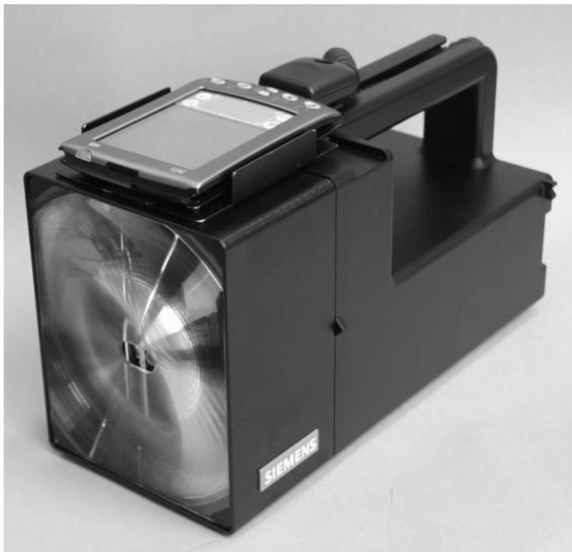
Figur 9.6. VOGUE Siemens AG, CT PS 8 Remote Natural Gas Leak Detector Field Unit (för teknisk specifikation, se bilaga 2).
