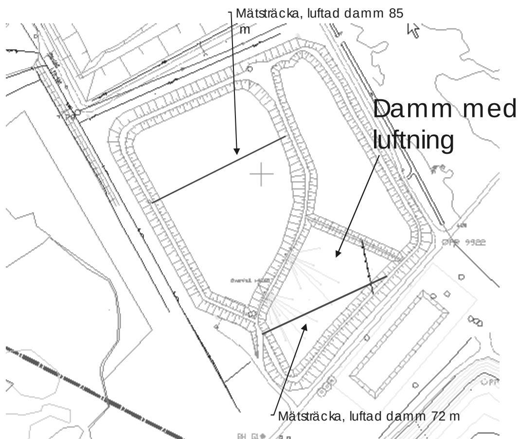
Figur 17.1. Situationsskiss över lakvattendammar vid Filborna med mätsträckorna för lasermätningarna inlagda.
