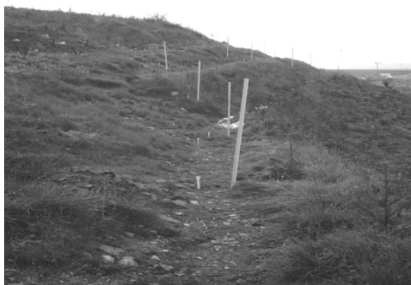
Figur 12.13. BC8, Spillepeng. Exempel på en vidsträckt slänt med gasemissioner från 22 läckagekällor med metanmissioner från 760-6800 ppm.
