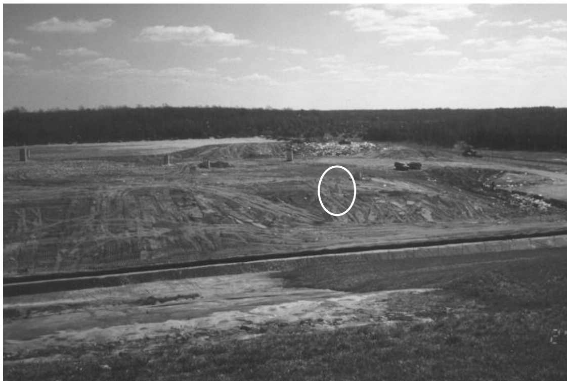
Figur 9.4. Testyta för markbaserad och flygburna test av simulerade gasläckage från avfallsupplag, Filborna, Helsingborg. Vertikalt gasrör som visas i figur 9.5 är inringat på bilden.
