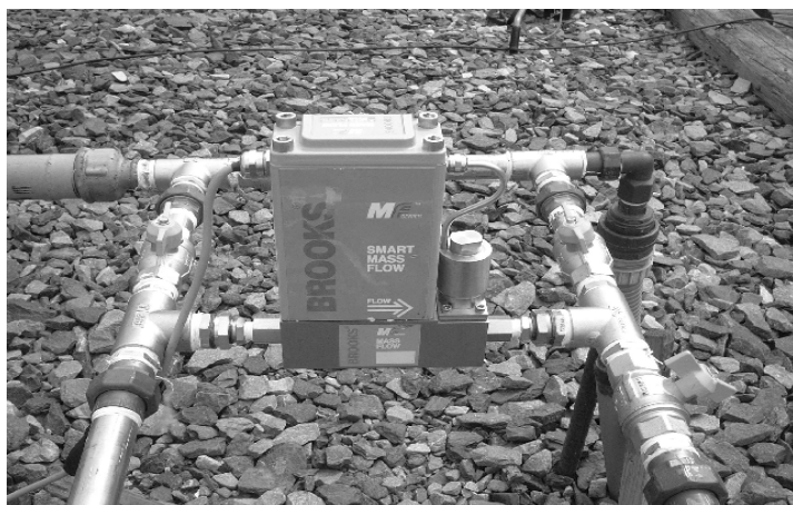
Figur 12.3_ Brooks “Smart Mass Flow Meter”, 5800 serien, för reglering av metangasflöden (v). Brooks mikroprocessor (0154 BC1B3) för att selektera och kontrollera gas mass-flöde (h).
