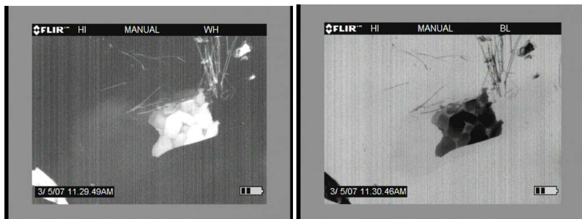
Figur 12.36. (a-b) visar värmebilder från registrering vintertid med IR-GasFinder systemet för samma objekt, lakvattenstenkistan, som i figur 12.35 (a-c), vintertid. Ett gasmoln kan svagt urskiljas genom det ljusgrå avvikande respektive mörkgrå avvikande strålningstemperaturmönstret i värmebilderna, bild (a) respektive bild (b). Videofilmen från vilken bilderna är hämtade visualiserar emission av ett tydligt gasmoln från stenkistan.
