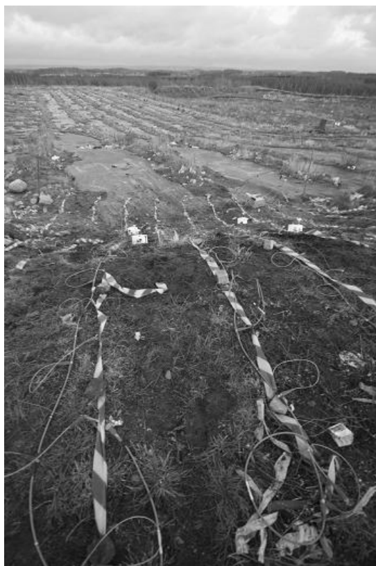
Figurer 14.5 och 14.6. Kablar och elektroder som för strömmen ner i marken.
