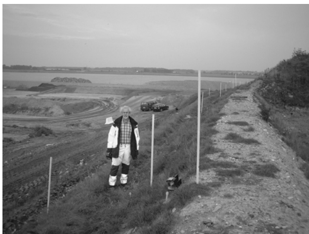
Figur 12.13. BC8, Spillepeng. Exempel på en vidsträckt slänt med gasemissioner från 22 läckagekällor med metanmissioner från 760-6800 ppm.
