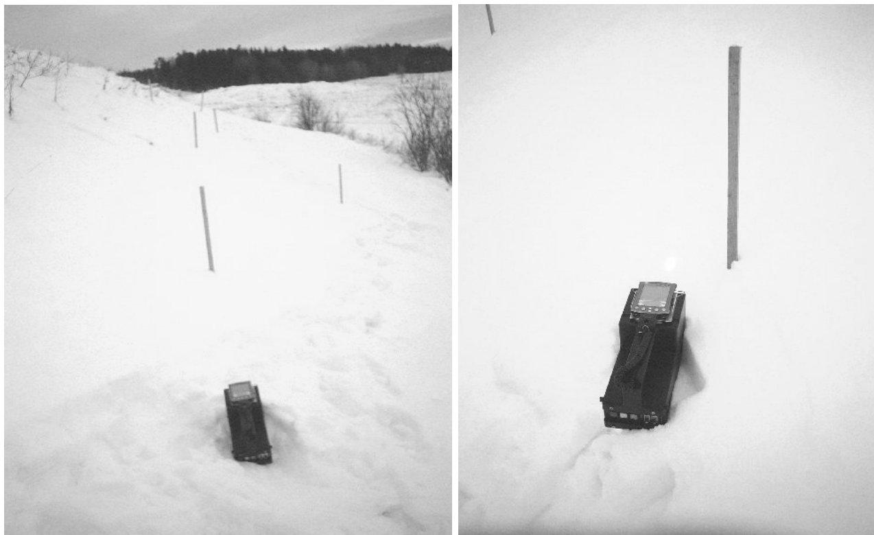
Figur 12.33. a) Översiktbild över objekt L1-6 – L1-1, västra slänten, Lötdeponin. b) Objekt L1-3, gasläckage genom orört poröst snötäcke (20-30 cm), \geq 5000 ppm.
