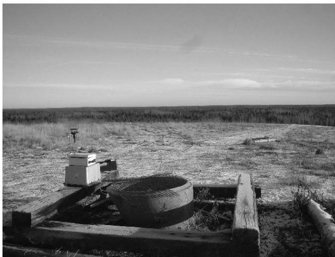
Figur 12.30. Högdaladeponin, laser- väderstation och loggersystem placerad uppe på platån, med lasern riktad utmed platån i SO-riktning, Högdala, 0-500 ppm x m.
