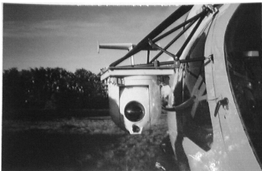
Figur 9.1. Högupplösande AGEMA Thermovision 1000 långvågs värmekamera, 8-14 \mu\text{m} , monterad i en GIMBLE, ARGUS 350 Stable Eye type C, stabiliserande plattform, med en Hughes 500 helikopter som instrumentbärare.
