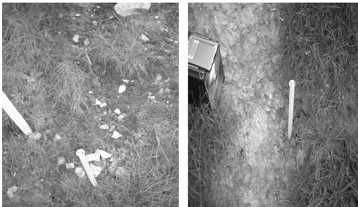
Figur 12.14. visar smala, visuellt knappt synbara sprickor som ger mätbara metanemissioner, samt mossart med kort rotsystem.
