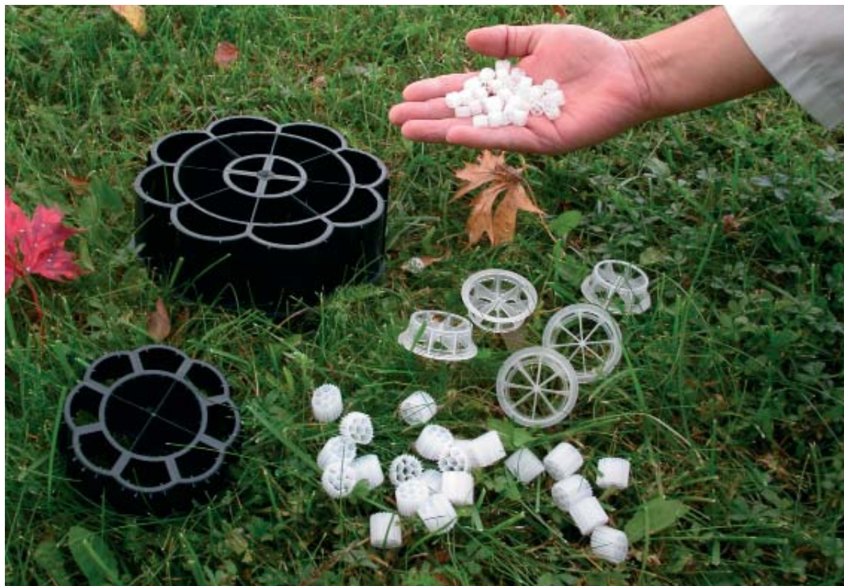
Figur 7. Plastringar kan användas som bärrmaterial i anaeroba filter. Foto: Åsa Jarvis.
