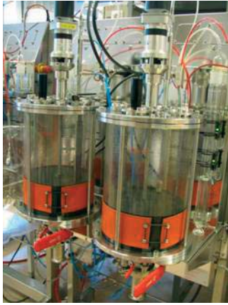
Figur 4. Kontinuerliga biogasreaktorer i laboratorieskala (8 L). Foto: Anna Schnürer.
