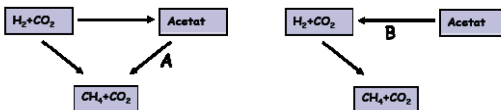
Figur 7. Två olika metanbildningsvägar från acetat är kända; klyvning av acetat av en acetotrof metanogen (A) eller oxidation av acetat till vätgas och koldioxid av en icke metanogen bakterie (B) följt av en reduktion av koldioxid till metan av en hydrogenotrof metanbildare.
