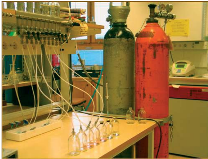
Figur 5. Odling av metanbildare i förslutna serumflaskor. Luften i flaskorna ersätts med en gasblandning av kvävgas och koldioxid med hjälp av gasutrustningen i bakgrunden.
