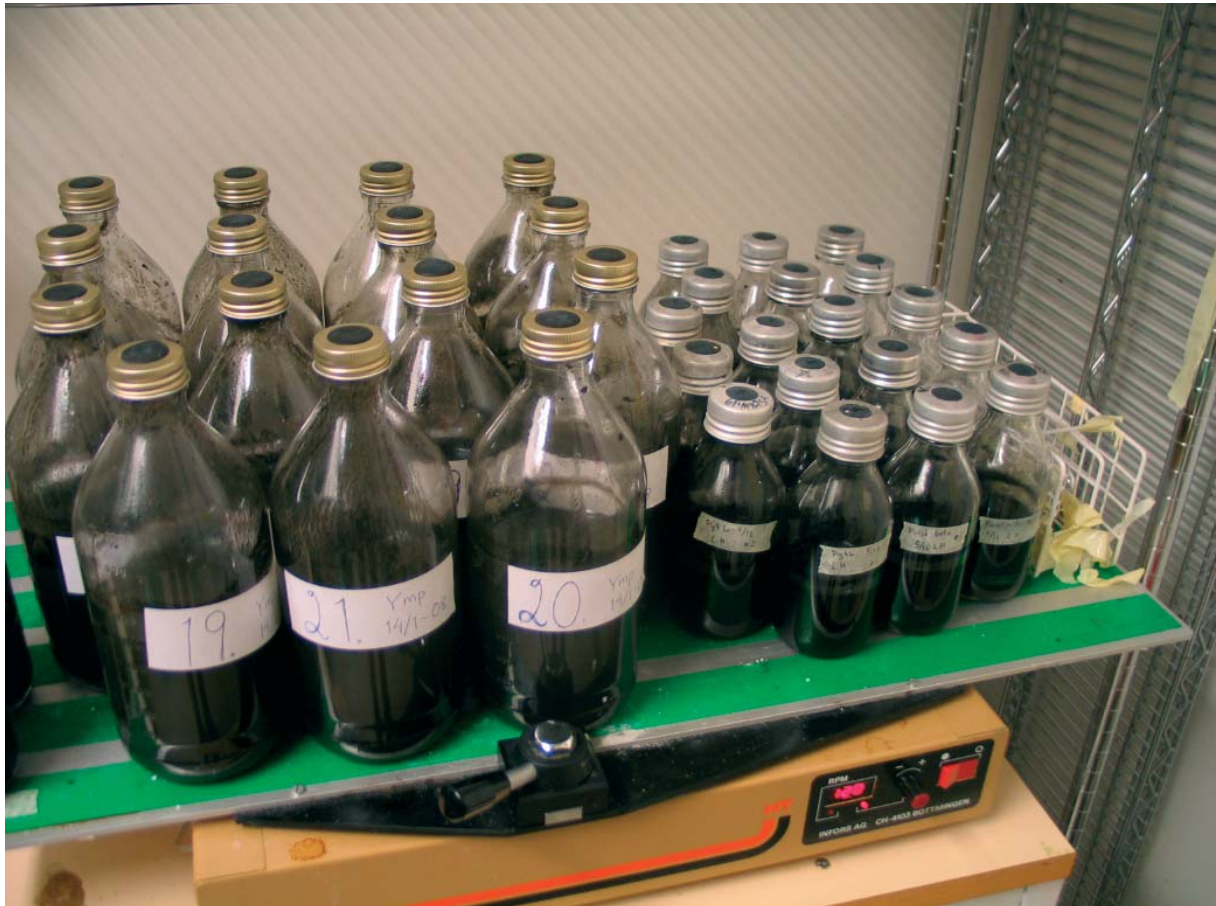
Figur 2. Satsvis utrötningsförsök. Flaskorna står på ett skakbord. Foto: Anna Schnürer.
