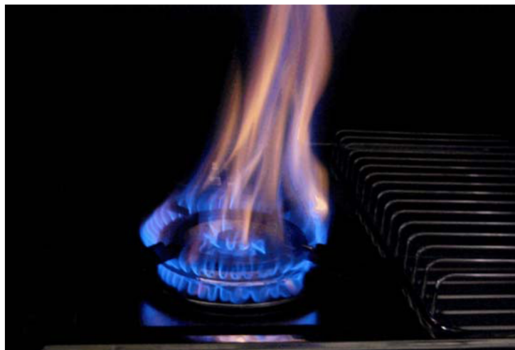
Figur 6. Ofullständig förbränning i spisbrännare.
