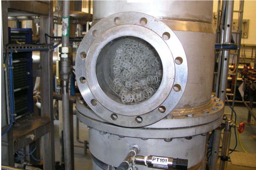
Figur 3.1 En vattenskrubberkolonn fylld med fyllkroppar. 20
