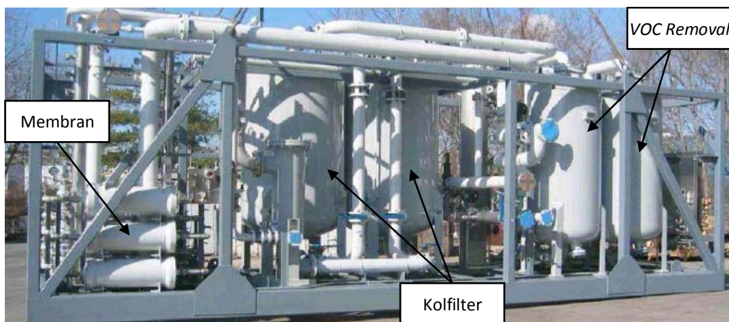
Figur 4.12 Typiskt utseende på Air Liquides membranmodul, med VOC Removal, Kolfiler och Membran utmärkta på bilden 32 .
