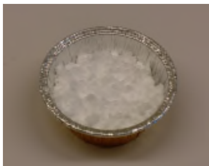
Figur 24. Struvit från försöken med syntetiska lösningar.
