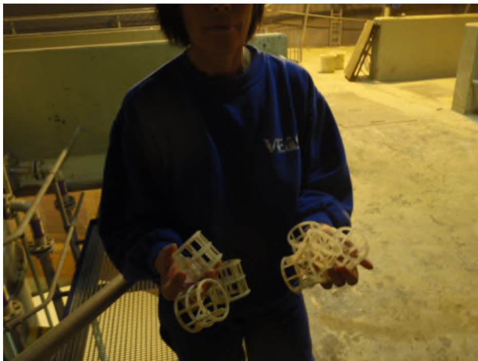
Figur 6.13. Fyllkroppar till kolonnerna
