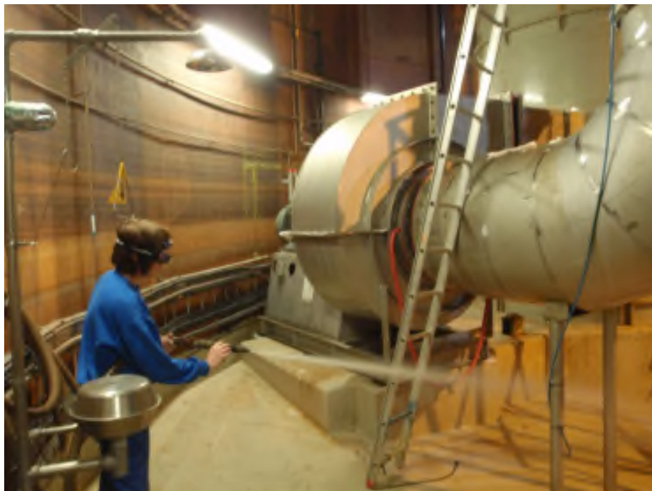
Figur 6.17. Anläggningen måste hållas ren från kristallint ammoniumnitrat
