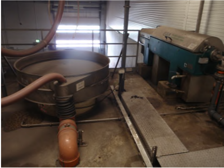
Figur 6.3 Hålsil för avskiljning av plast (t v) och dekantercentrifug (t h)
