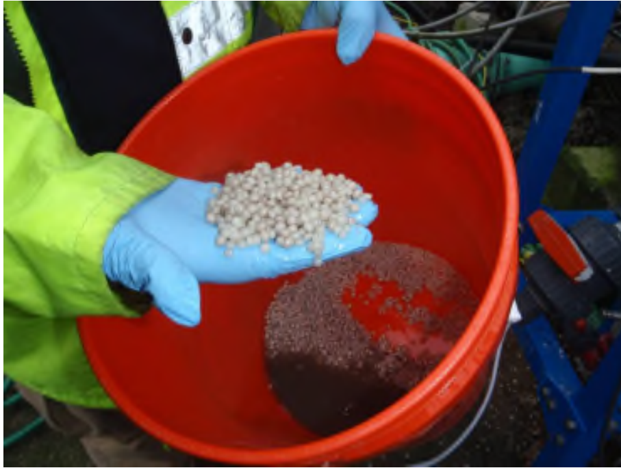
Figur 6.23 Bild på struvitgranuler som togs ut i Slough under pilotkörning
