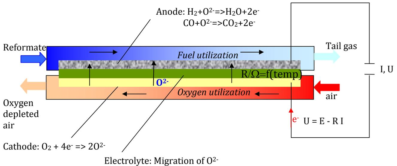
Figure 9a, Solid Oxide Fuel Cell
