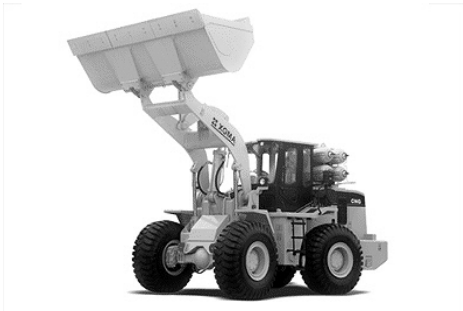
Figur 2. Exempel på placering av gastankar där tankarna skymmer sikten för föraren. © Xiamen XGMA Machinery Co., Ltd
