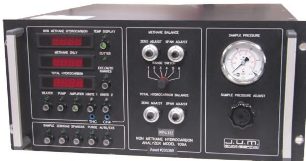
Figur 2. FID-instrument med inbyggd Cutter från tillverkaren JUM. Bildkälla: cleanair.com
