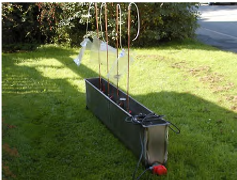
Figur 31. Provtagningsutrustning för mätning av metan i vatten. Bildkälla: BioMil
