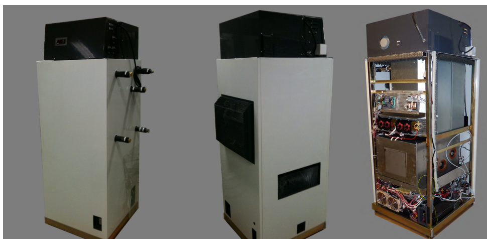
Figur 6.5. ComfortPower, en hybrid mellan värmepump och bränslecellsteknologi, visat framifrån, från sidan samt utan ytterhölje. Från ovensidan räknat syns kontrollsystem, värmepumpsmodul och bränslecellstack inkl. blyackumulator (vid ö-drift) och elkonditioneringssteg. V=600 \times 600 \times 1650 mm, vikt=240 kg.
