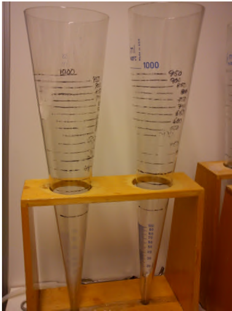
Figur 5-1. Uppställning för sedimentationsförsök.
