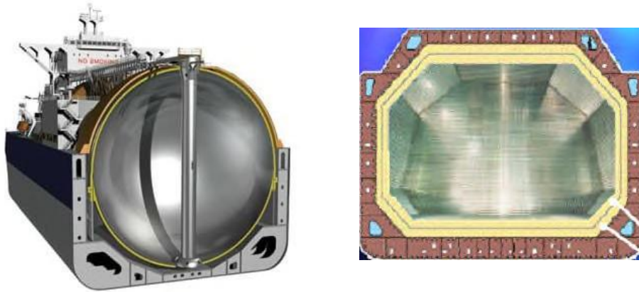
Figur 15. Tankar av Mosstyp (vänster) och membrantyp (höger) (Luketa, Hightower, & Attaway, 2008).
