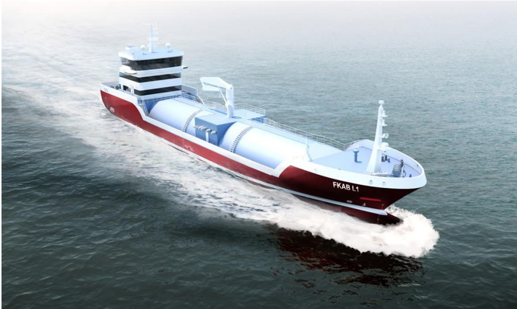
Figur 20 LNG bunkerfartyg Källa:FKAB
