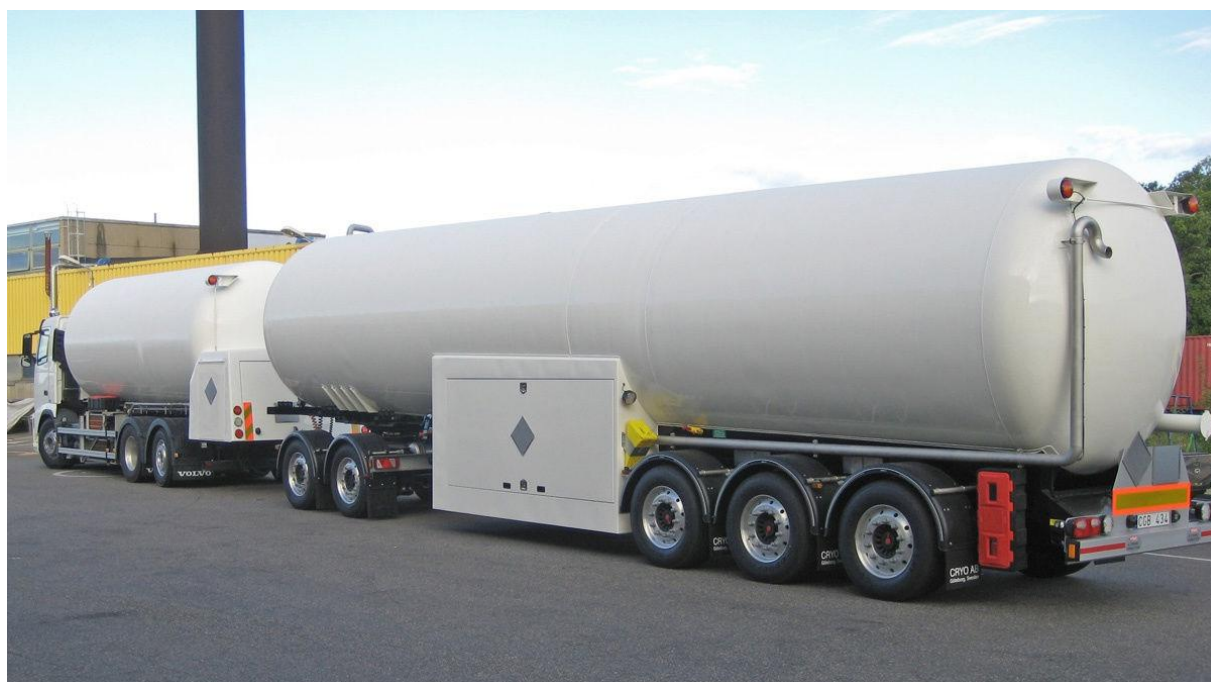
Figur 9 Semitrailer med släpvagn för transport av LNG. Källa: Cryo AB
