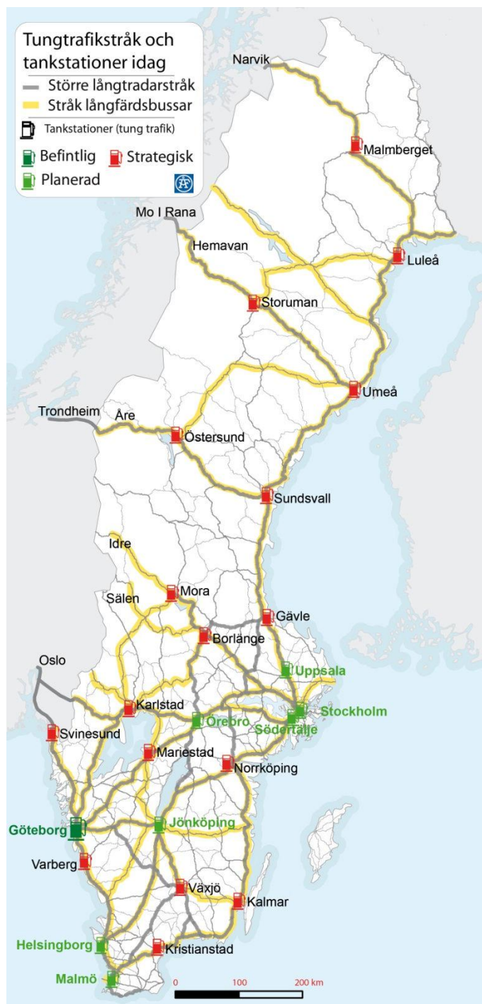
Figur 17 Tungtrafikstråk och befintliga samt planerade tankstationer. Källa: ÅF, 2011
