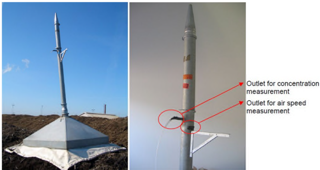
Figur 12. Provtagningshuv vidareutvecklad av Rambøll och DTU. (14)
