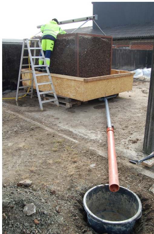
Figur 8: Försökuppställning för spårämnesförsök med försöksbädden i bakgrunden och anordning för uppsamling och mätning av utgående vatten i förgrunden. Foto: H. Rosqvist.
