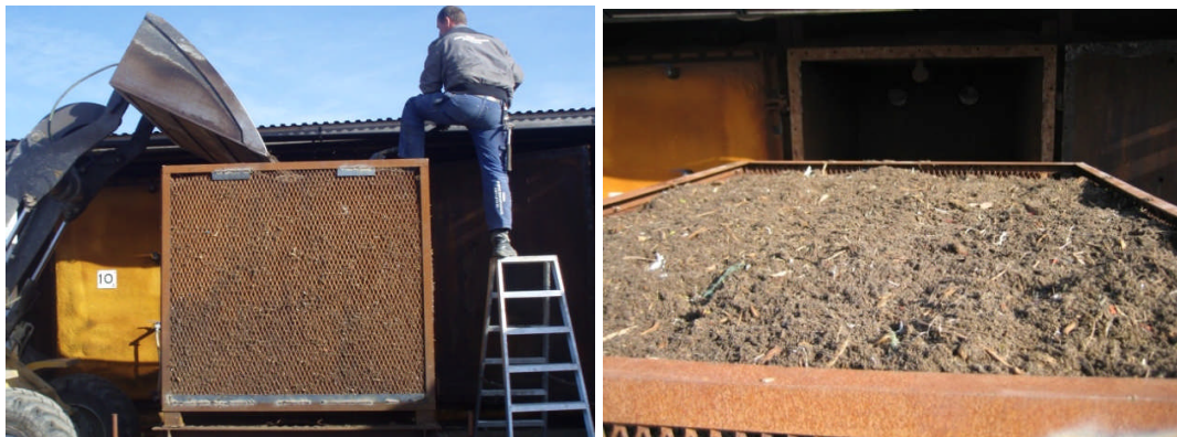
Figur 6: Inlastning av blandningen av rejekt och strukturmateriel i lakbäddsreaktorn. Foto: M. Murto.
