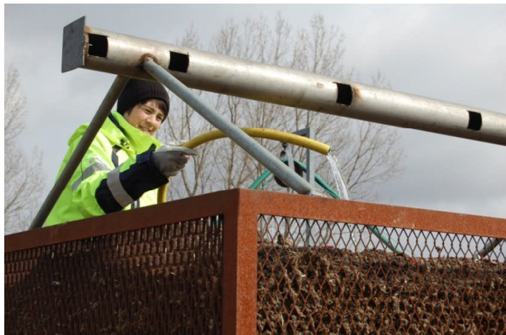
Figur 10: Manuell uppfuktning av försöksbädden med slang. Fotot visar även anordning för bevattningsröret som användes under spårämnesförsöken. Foto: H. Rosqvist.
