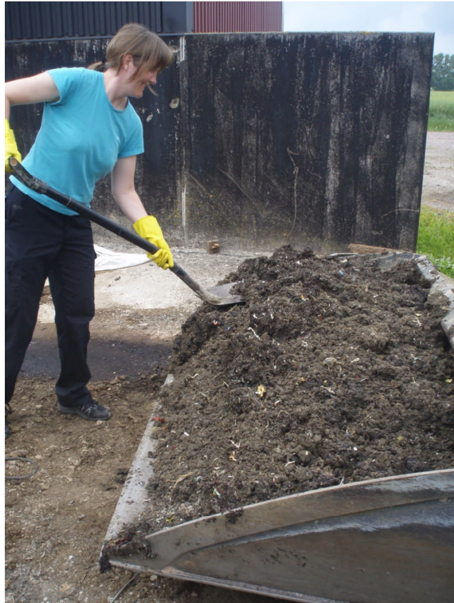
Figur 3: Provtagning gjordes genom uttag av tre delprov från varje in/utvägd skopa. Foto: L. Björnsson.
