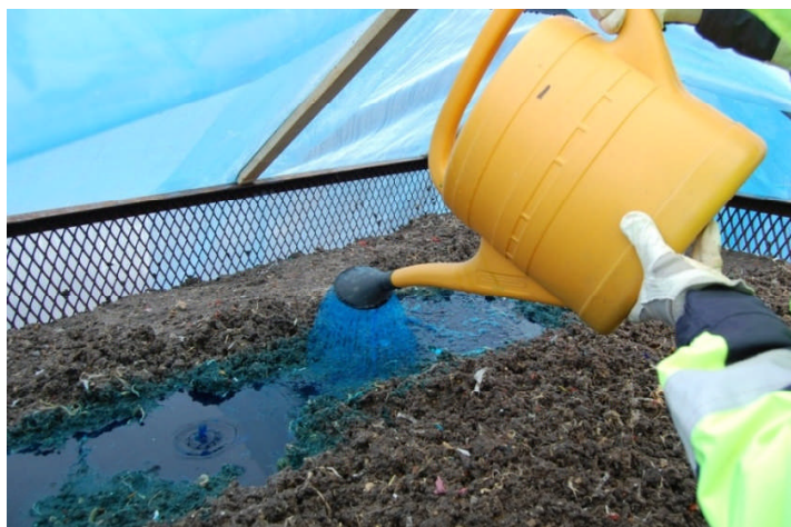
Figur 11: Applicering av spårämnespulv för hand med strilkanna. Foto: H. Rosqvist.
