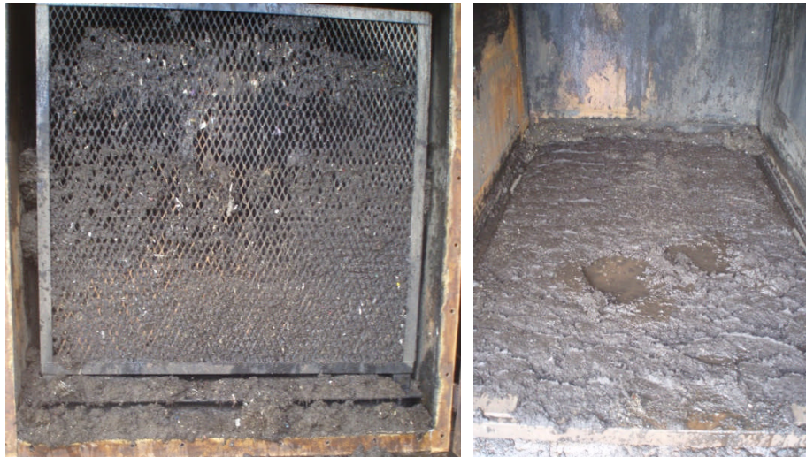
Figur 16: Rötrest i lakbäddsreaktor och sörja i botten efter avslutad rötning av rejekt. Foto: L. Björnsson.
