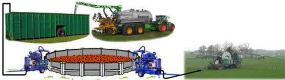
Figur 5: Mobil pumpning med container som satellitlager vid fältkanten för tankvagn alt. slangspredning med ramp 7
