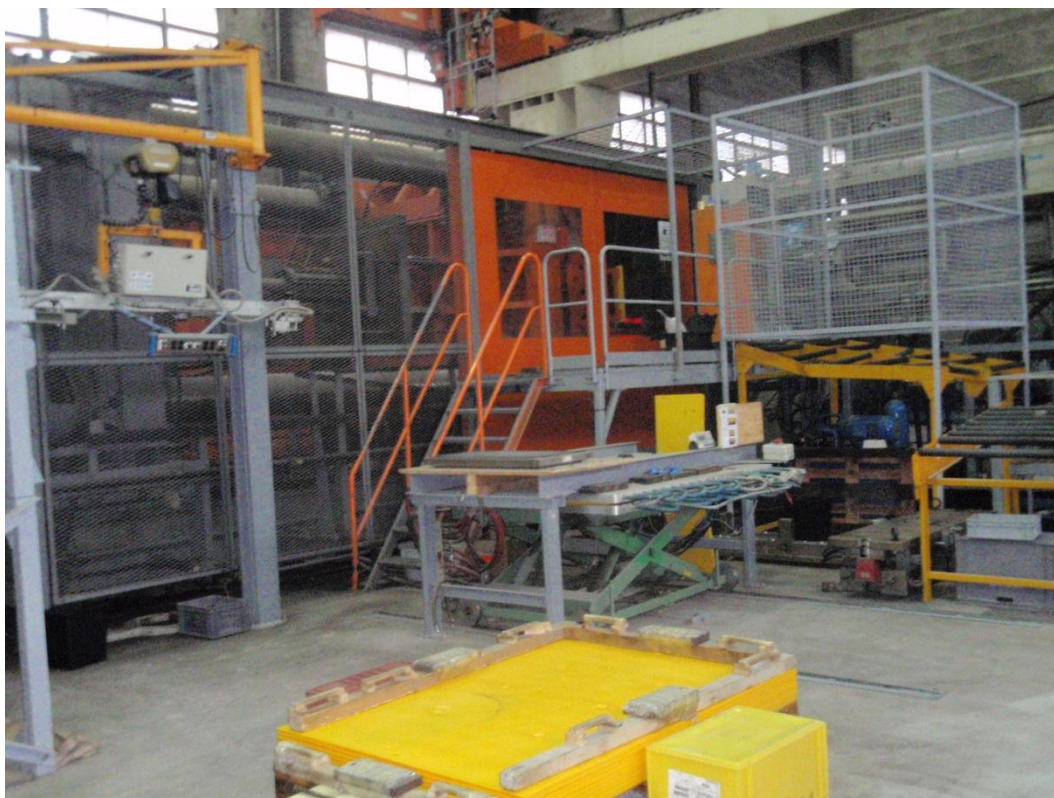
Figur 1: Formspruta för tillverkning av Overpipes grävskyddsplattor.
