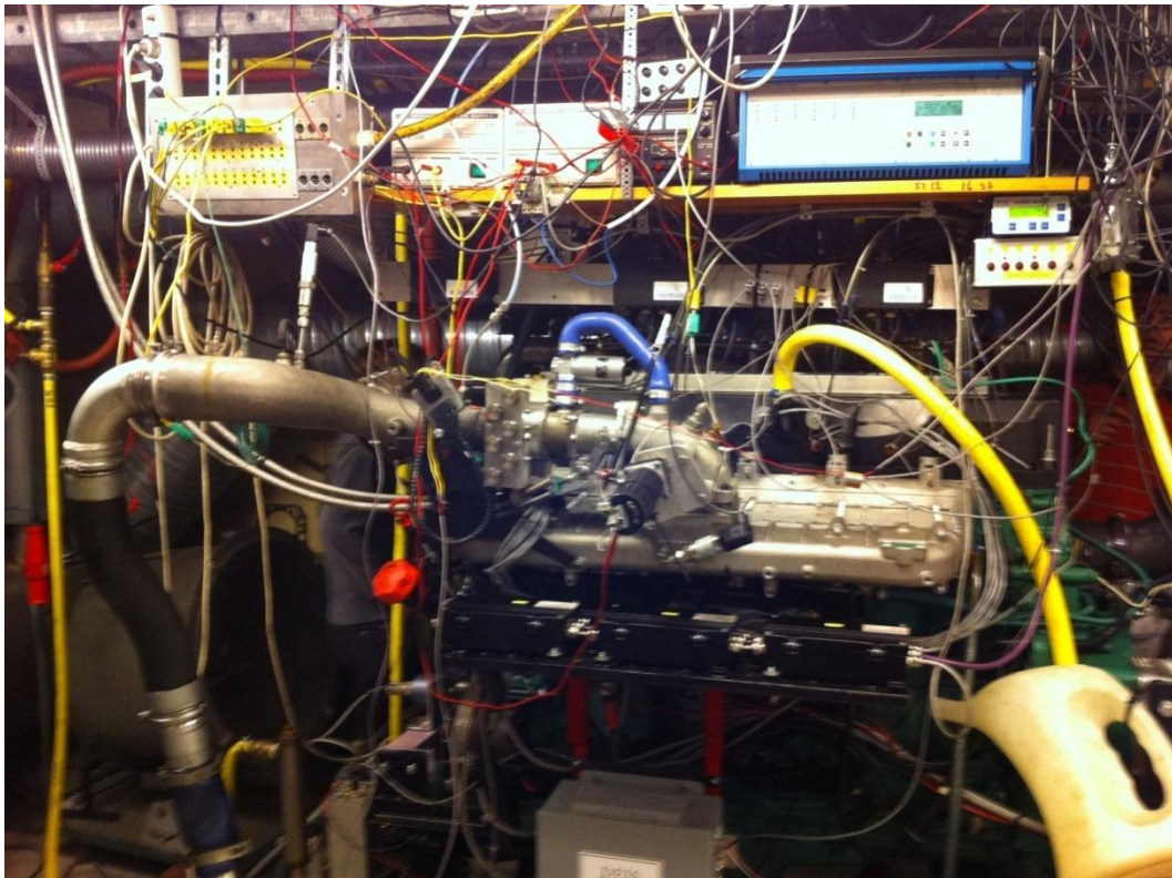
Figur 23. Tung naturgasdriven lastbilsmotor i Lunds Tekniska Högskola.
