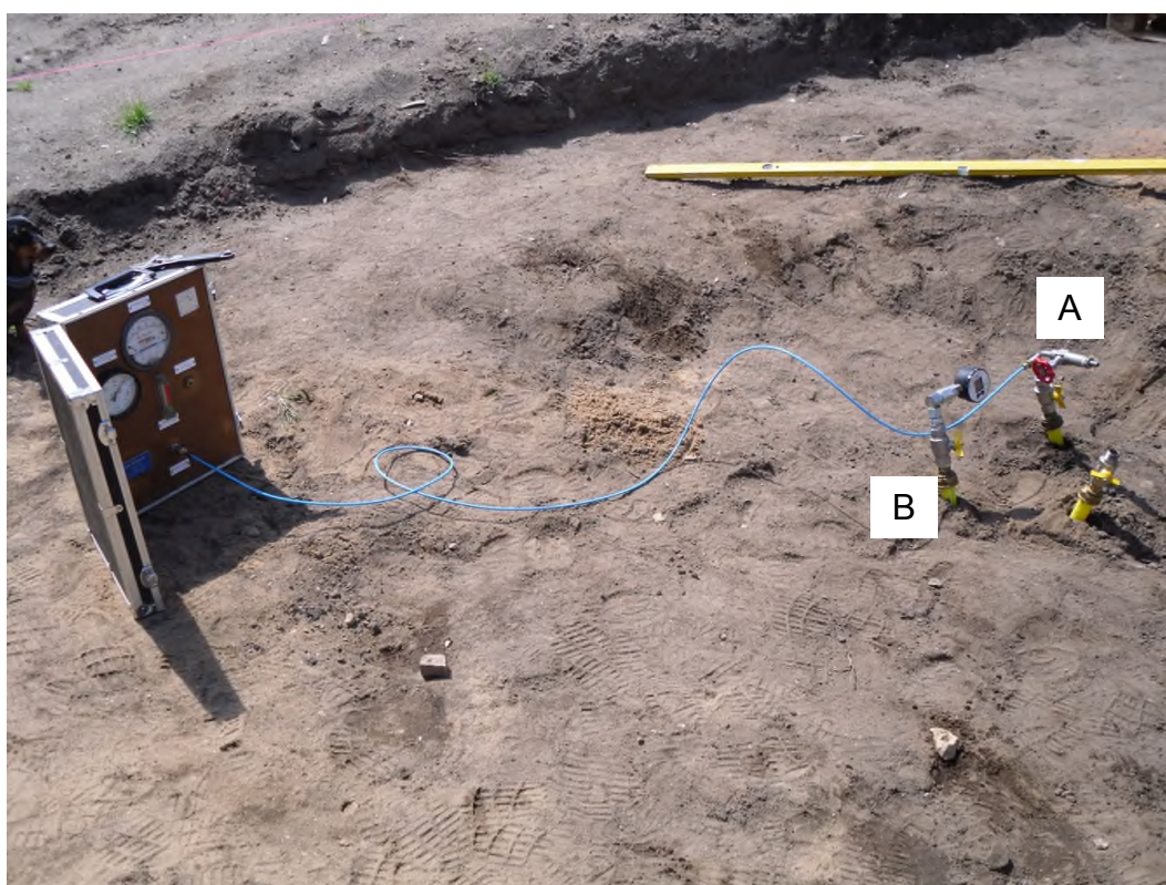
Figur 12. På bilden ses differenstryckmätning för mätobjektet A, anslutet med den blå slangen, och precisionsmätning för mätobjektet B som har en precisionsmätare ansluten.
