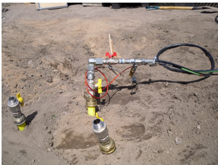
Figur 11. Mätobjekten trycksattes med kvävgas.
