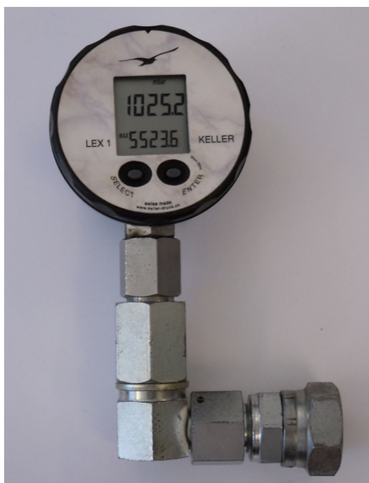
Figur 4. På bilden ses en digital precisionsmätare. Tydligt var lufttrycket 1025,2 mbar när bilden togs.
