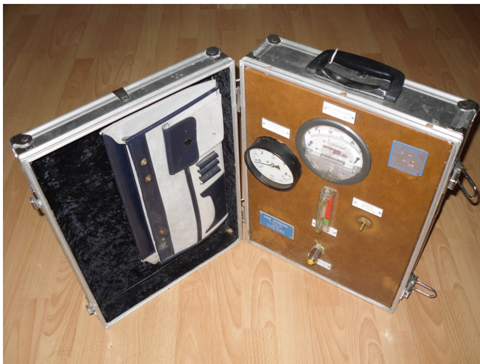
Figur 3. På bilden ses utrustning för differenstryckmätning. Referensbehållaren finns inuti lådan bakom mätartavlorna.
