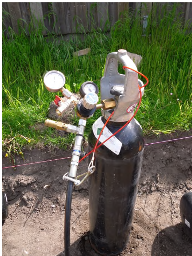
Figur 10. På bilden ses flaskan med kvävgas som användes för att trycksätta mätobjekten. Notera den röda säkerhetswiren mellan flaska och påkopplad slang.
