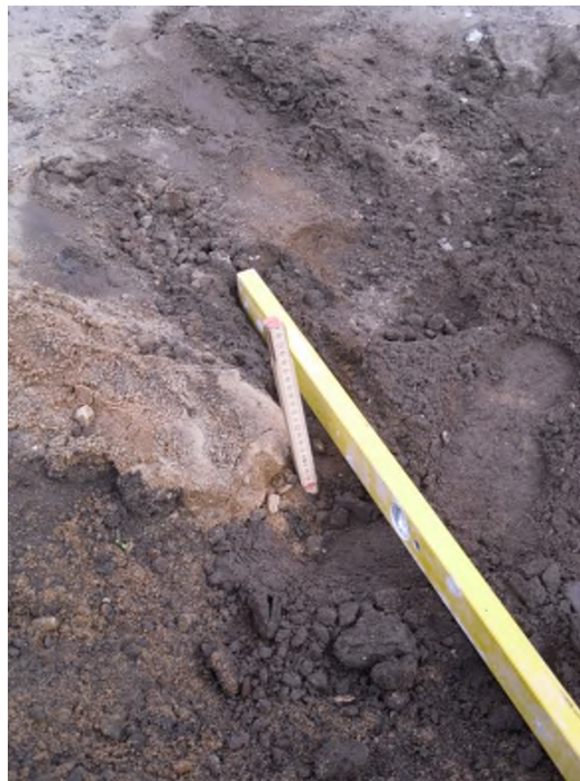
Figur 7. Gropen fylldes igen med de utgrävda massorna (torr sand) så att mätobjekten låg på ca 750 mm djup.
